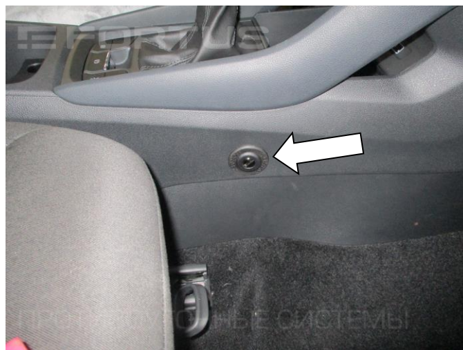
26. Проверьте работоспособность замка, сорвите крепеж, соберите консоль
