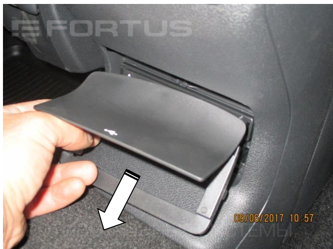
13. Снимите накладку консоли
