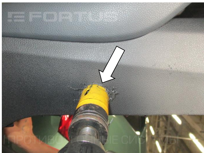
25. Разметьте и просверлите отверстие под корпус замка \varnothing 32 мм
