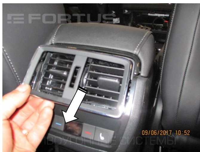
10. Снимите накладку консоли
