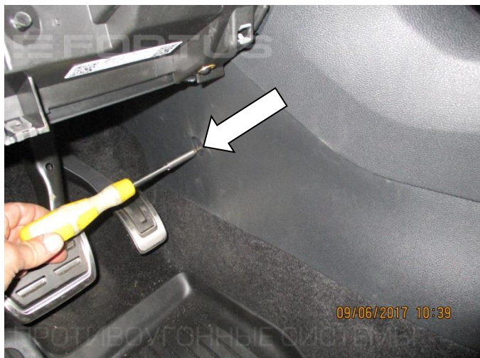
7. Открутите винт крепления консоли с обеих сторон
