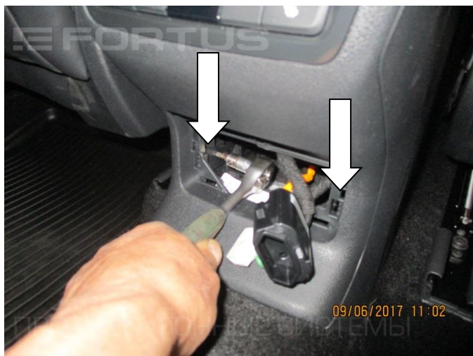
15. Открутите два винта крепления консоли
