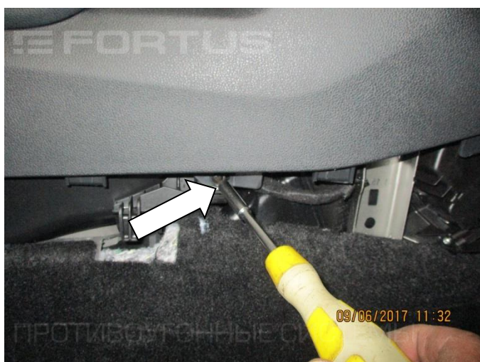
9. Открутите винт крепления консоли с обеих сторон
