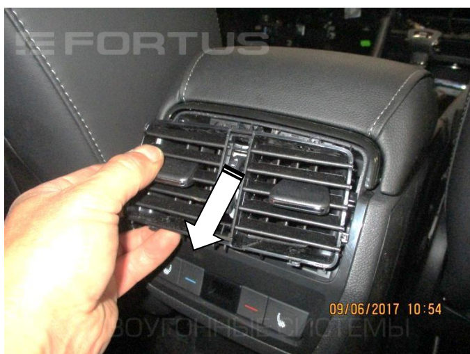
11. Снимите накладку консоли
