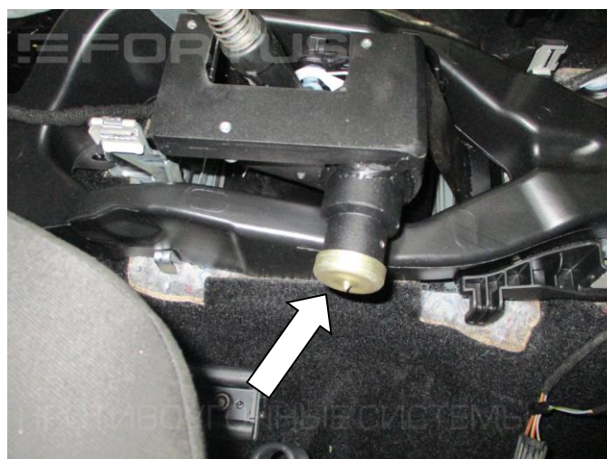
24. Установите шаблон SCH7 на корпус замка
