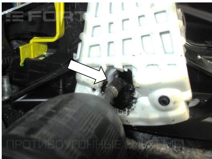
9. Удалите часть пластика рычага КПП так, чтоб
