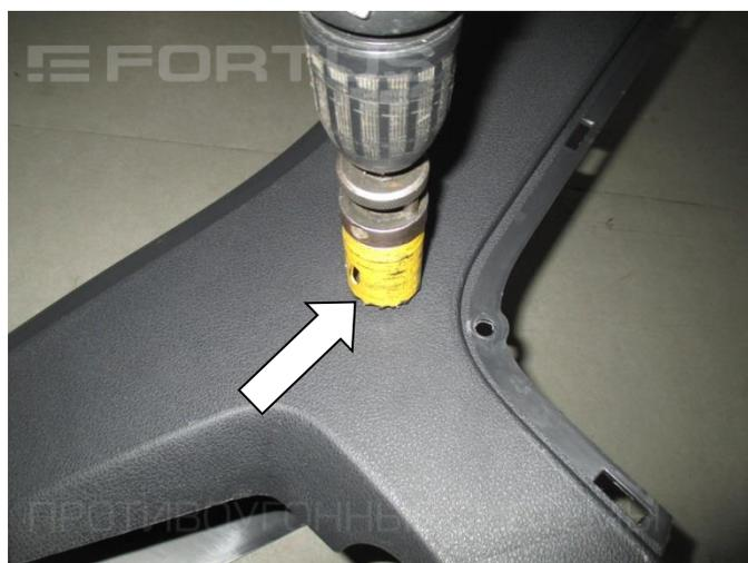
**16.** Разметьте и просверлите отверстие под корпус замка  $\varnothing 32$  мм
