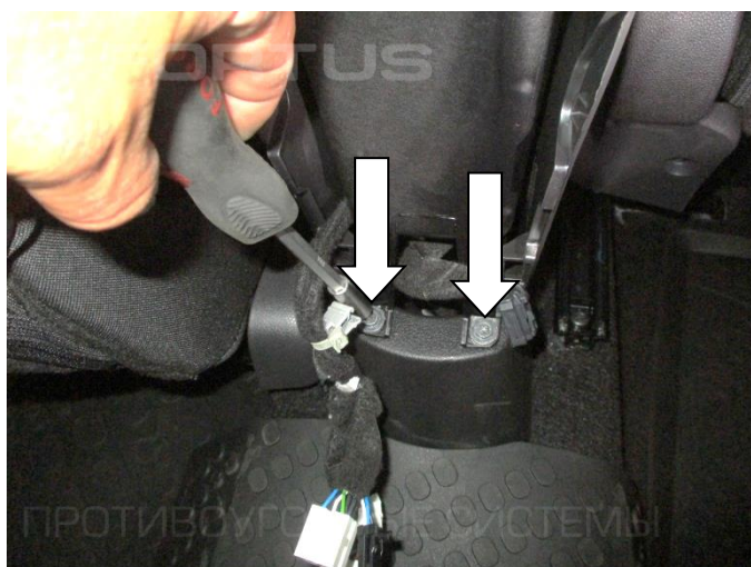
5. Открутите два винта крепления консоли
