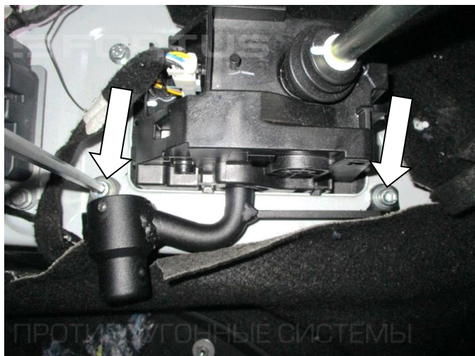
19. Установите замок (поз. 1) и закрепите двумя болтами (поз. 3) с шайбами (поз. 4). Проверьте работоспособность замка и селектора
