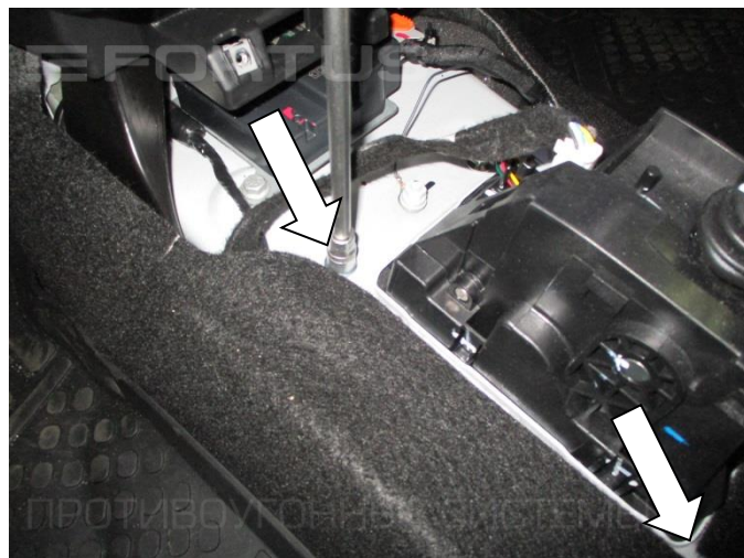
14. Открутите два болта крепления селектора
