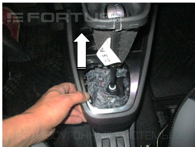
10. Снимите накладку консоли
