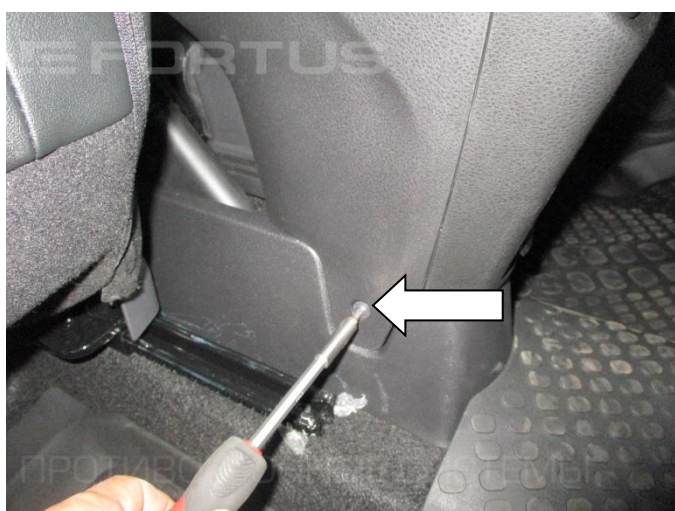
3. Открутите по одному винту крепления консоли с обеих сторон
