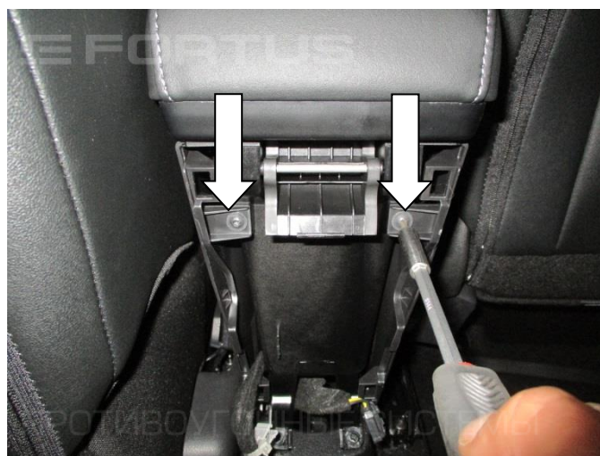
6. Открутите два винта крепления консоли
