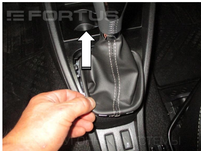
2. Отсоедините кожу рычага КПП
