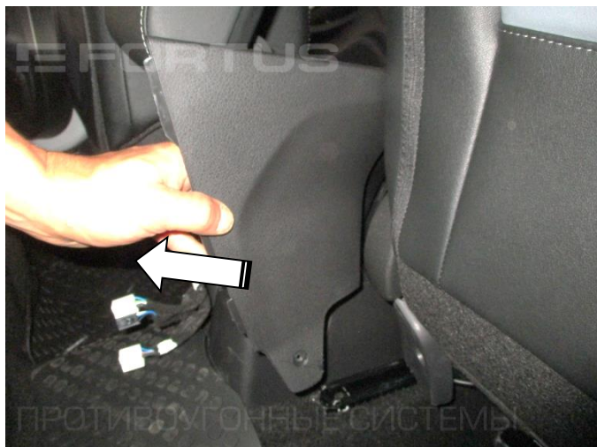
7. Снимите наклейки консоли с обеих сторон
