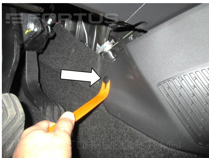
9. Извлеките пистон крепления консоли с обеих сторон
