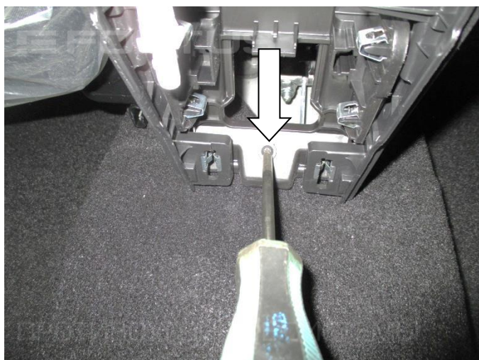
13. Открутите винт крепления консоли
