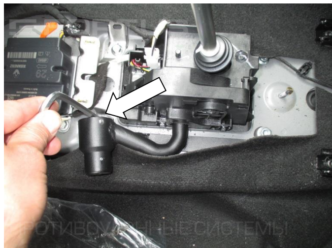
26. Установите замок (поз. 1), закрепив с помощью болта (поз. 4) с шайбой (поз. 5)
