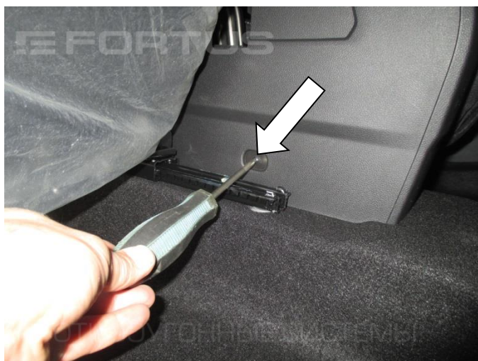
11. Открутите винт крепления консоли с обеих сторон
