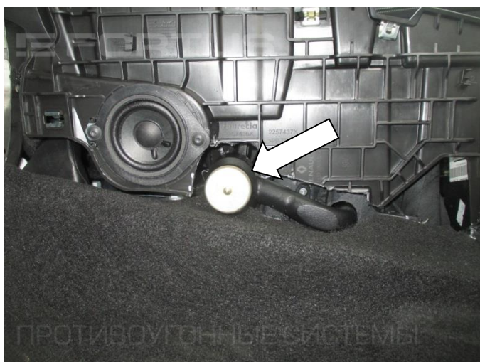
29. Установите шаблон SCH7 на корпус замка
