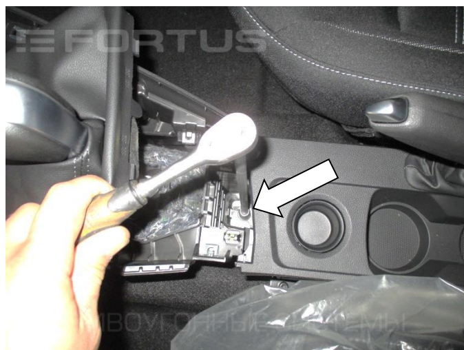
14. Открутите гайку крепления консоли
