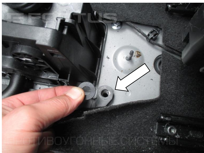
27. Установите проставку (поз. 2) под точку крепления замка (поз. 1)
