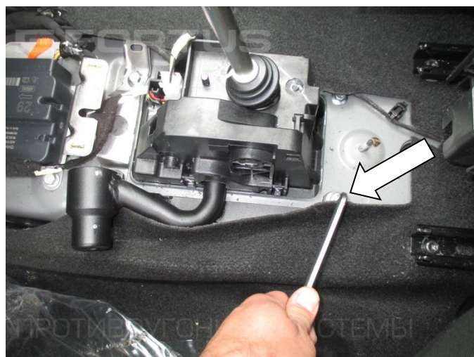
28. Закрепите замок (поз. 1) с помощью болта (поз. 4) с шайбой (поз. 5). Проверьте работоспособность замка и селектора
