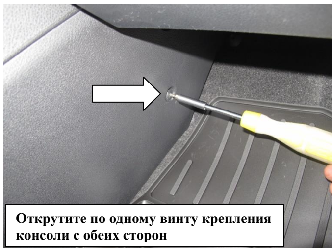
Снимите боковые накладки консоли с обеих сторон
