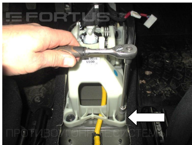
12. Открутите болт крепления селектора
