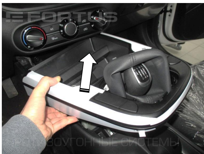
5. Снимите накладку консоли
