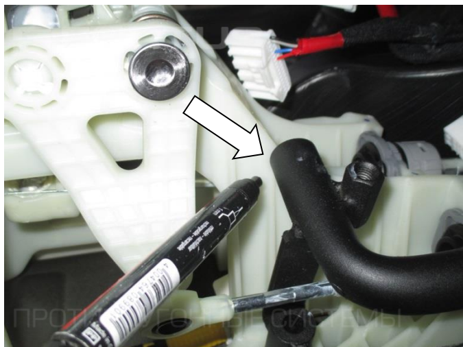
19. Приложите замок (поз. 1) по точкам крепления селектора. Наметьте центр сверления стенки селектора
