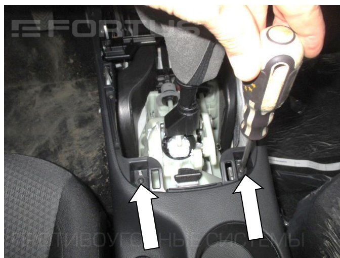
6. Открутите два винта крепления консоли
