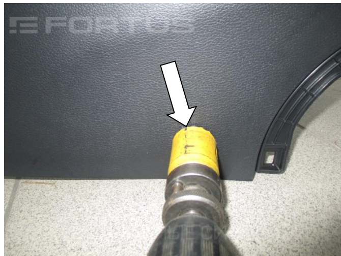
26. Разметьте и просверлите отверстие под корпус замка Ø32 мм
