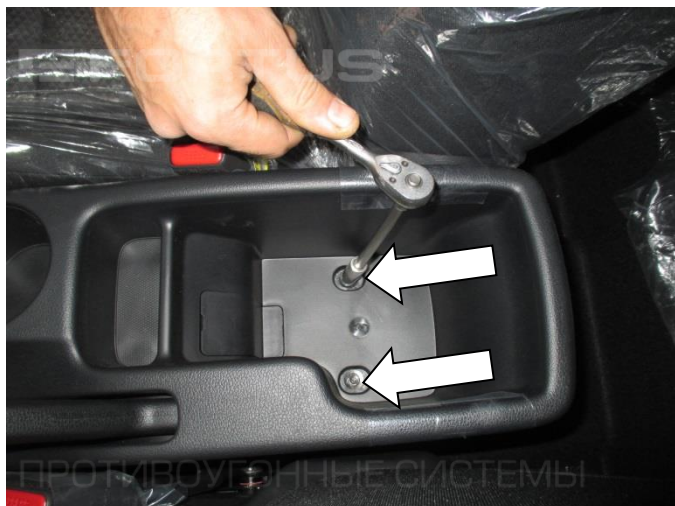
7. Открутите два болта крепления консоли
