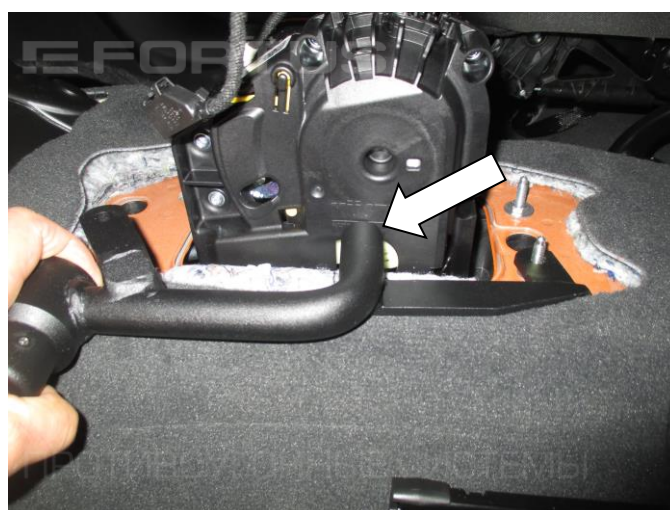
24. Приложите замок (поз. 1) по креплениям селектора, отметьте центр сверления стенки селектора
