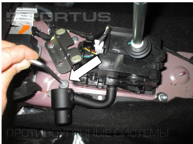
27. Установите замок (поз. 1), закрепив с помощью болта (поз. 3) с шайбой (поз. 4)
