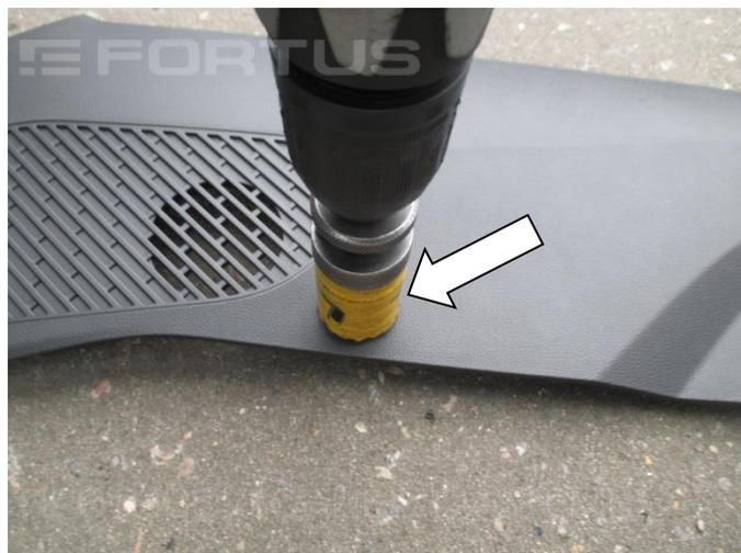
30. Разметьте и просверлите отверстие под корпус замка  $\varnothing 32$  мм
