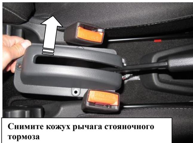
Снимите кожух рычага стояночного тормоза
