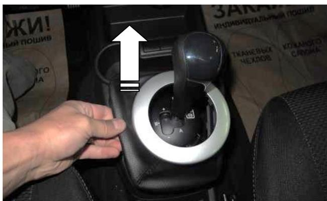
Снимите накладку рычага переключения передач КПП
