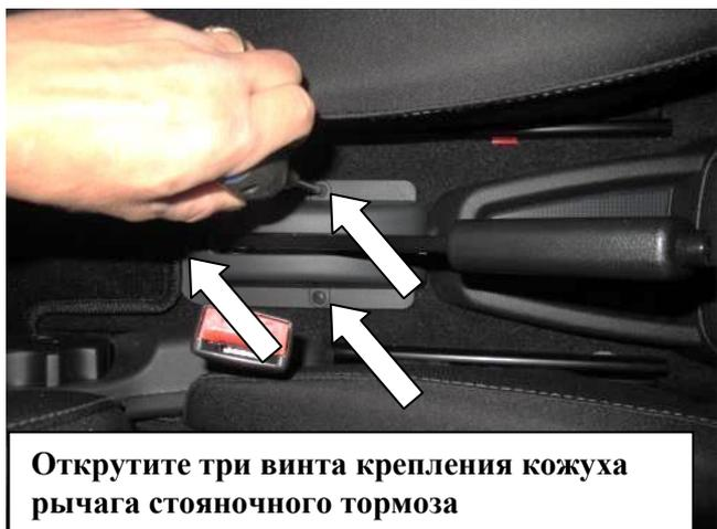
Открутите три винта крепления кожуха рычага стояночного тормоза
