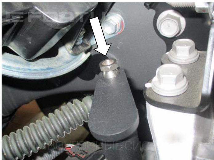
**31.** Установите кронштейн (поз. 5), закрепив с помощью гайки (поз. 10). (Подкапотное пространство)
