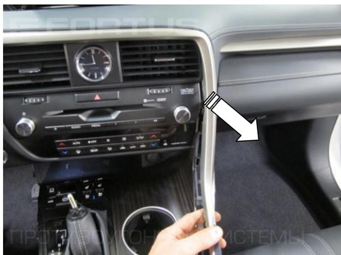
4. Снять накладку консоли
