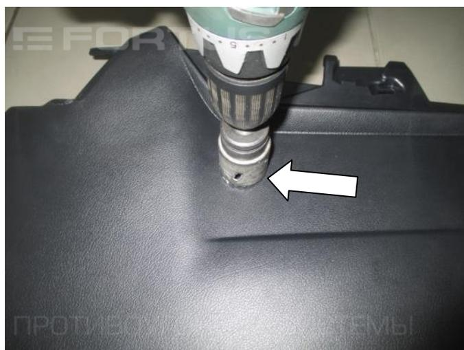
**28.** Разметьте и просверлите отверстие под корпус замка  $\varnothing 32$  мм
