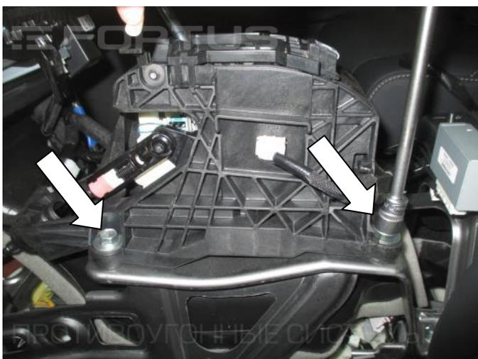
21. Открутите два болта крепления селектора
