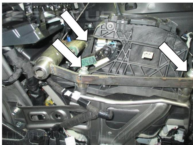
24. Установите замок (поз. 1), закрепив болтами (поз. 8, 9) с шайбами (поз. 11)
