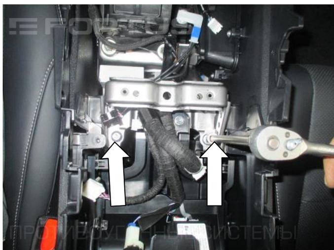
9. Открутите две гайки крепления кронштейна консоли
