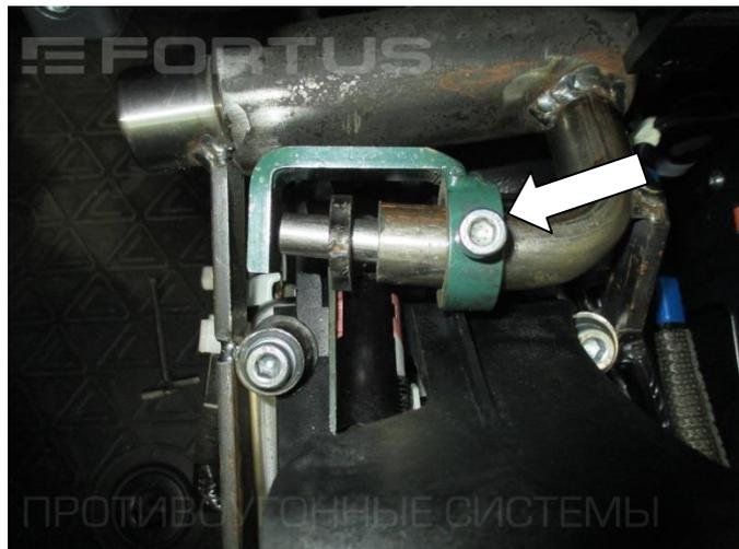
**26.** Установите кронштейн (поз. 3), закрепив болтом (поз. 7)
