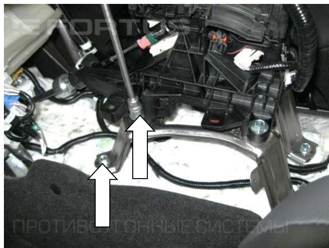
16. Открутите два болта крепления селектора
