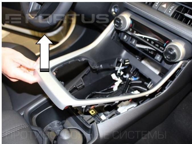
7. Снимите накладку консоли
