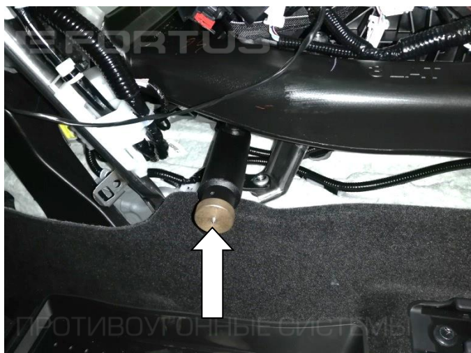
21. Установите шаблон SCH7 на корпус замка
