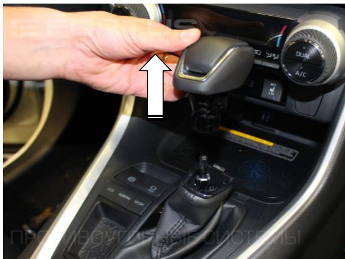
3. Снимите рукоятку рычага КПП
