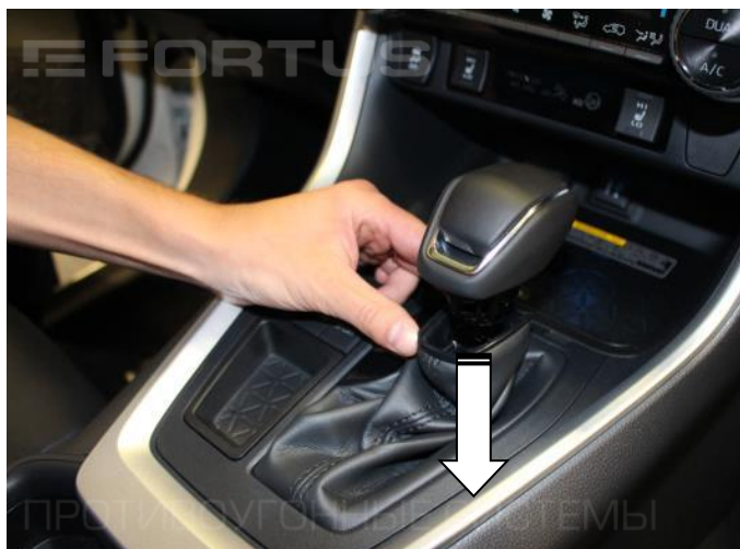
1. Отсоедините кожу рычага КПП
