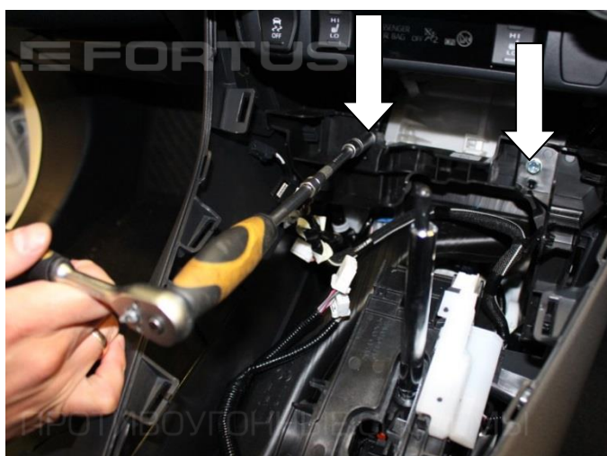
11. Открутите два болта крепления консоли
