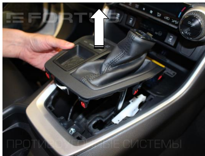
4. Снимите накладку консоли
