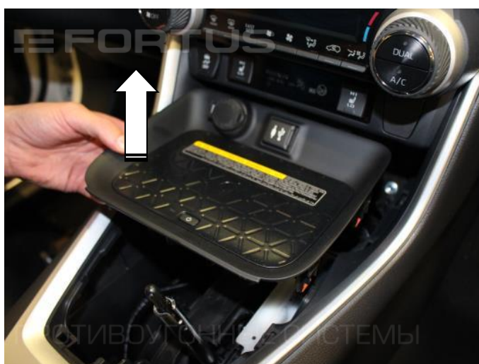
5. Снимите накладку консоли
