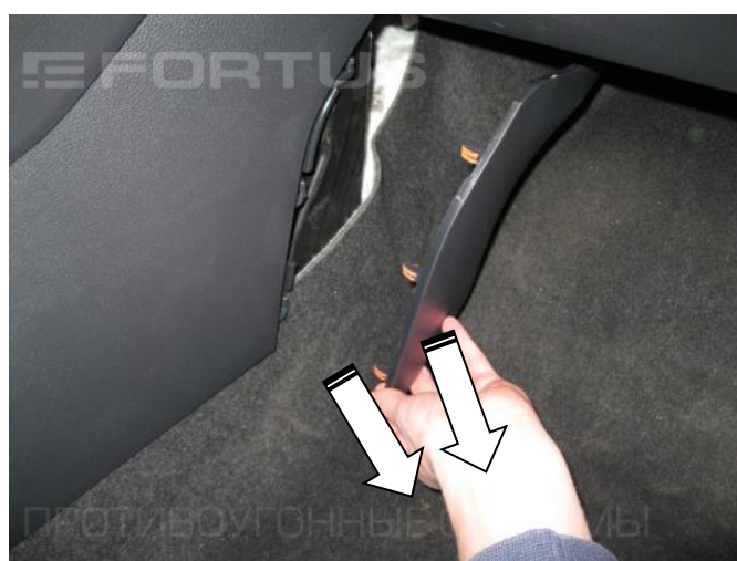
12. Снимите накладки консоли с обеих сторон
