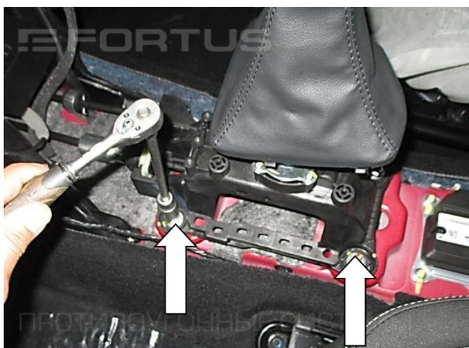
15. Открутите две левые гайки крепления селектора
