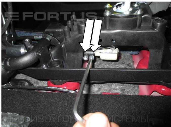
**19.** Установите хомут (поз. 2) и закрепите двумя болтами (поз. 5)
