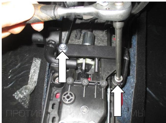
**20.** Установите кронштейн (поз. 3) и закрепите болтом (поз. 6) с шайбой (поз. 8) и гайкой (поз. 7).
