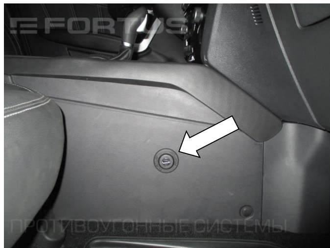
26. Проверьте работоспособность замка, сорвите крепеж, соберите консоль
