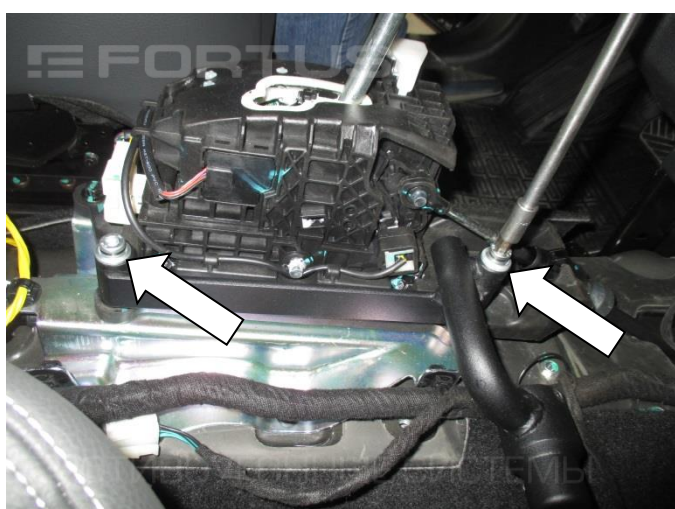
17. Установите замок (поз. 1), закрепив с помощью болтов (поз. 7, 9) с шайбами (поз. 10)
