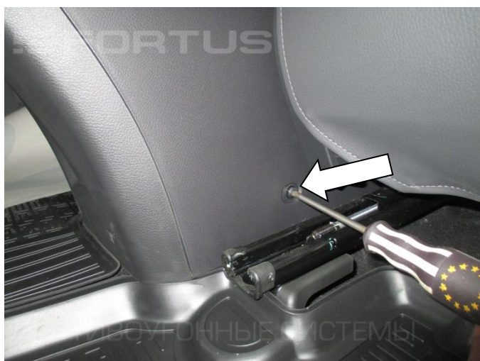
9. Открутите винт крепления консоли с обеих сторон
