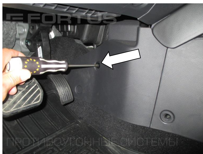
12. Открутите винт крепления консоли с обеих сторон
