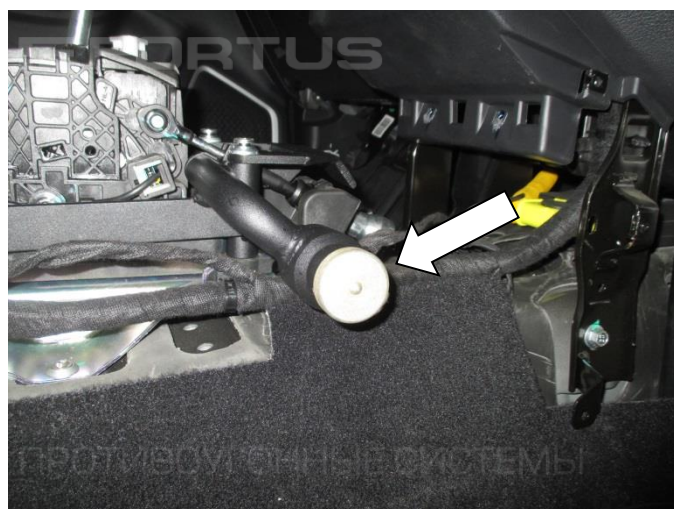
24. Установите шаблон SCH7 на корпус замка
