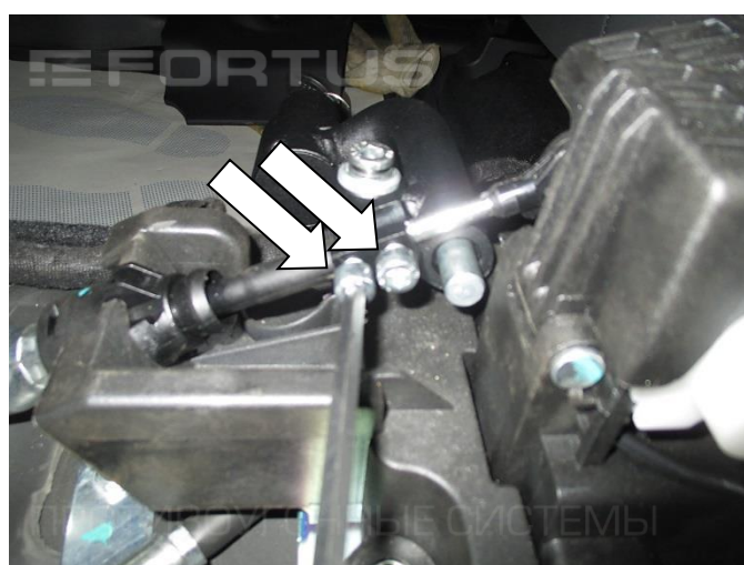
18. Установите прихват (поз. 2), закрепив с помощью болтов (поз. 6)
