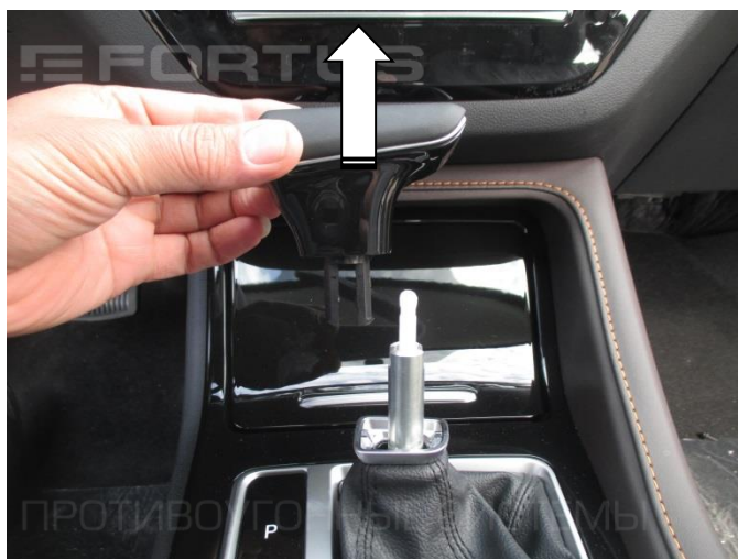
4. Снимите рукоятку рычага КПП
