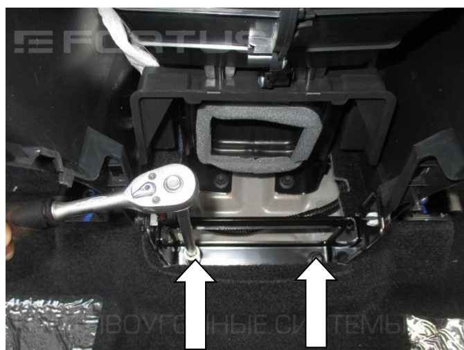
12. Открутите два болта крепления консоли
