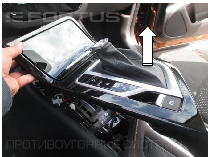
5. Снимите накладку консоли
