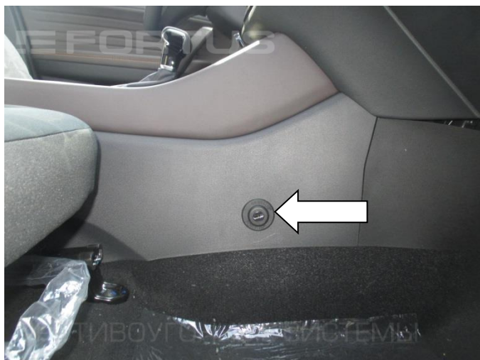
23. Проверьте работоспособность замка, сорвите крепеж, соберите консоль
