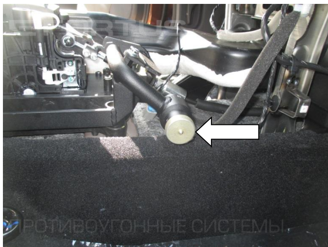
21. Установите шаблон SCH7 на корпус замка.
