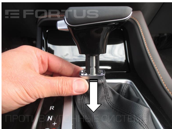
3. Отсоедините кожаную рукоятку рычага КПП
