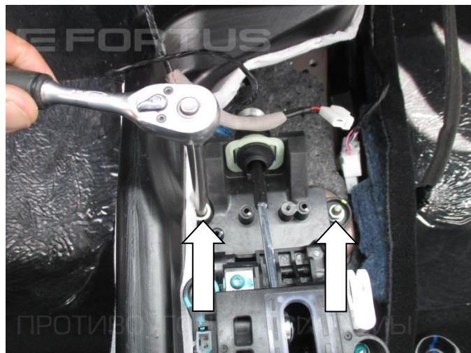
14. Открутите две передние гайки крепления селектора
