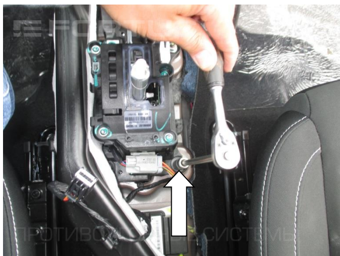
15. Открутите заднюю правую гайку крепления селектора
