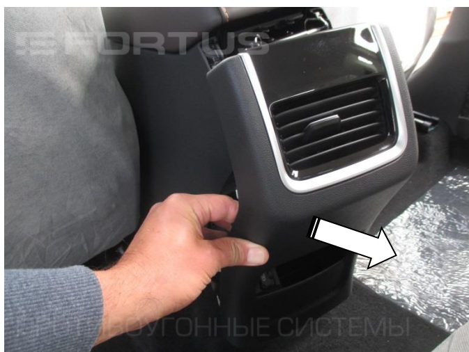
11. Снимите накладку консоли
