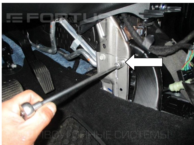
11. Открутите болт крепления кронштейна консоли
