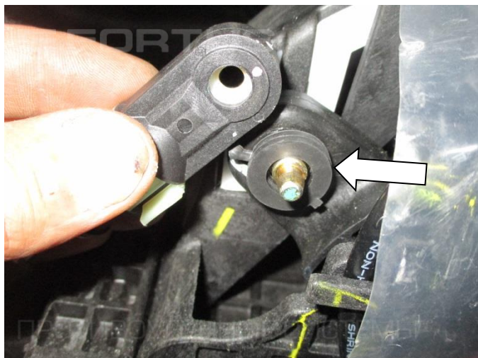
13. Установите две шайбы (поз. 12) на шарнир КПП
