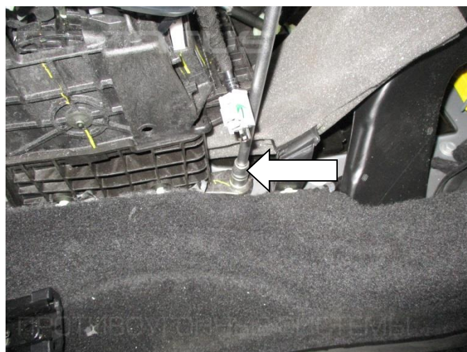
10. Открутите болт крепления селектора
