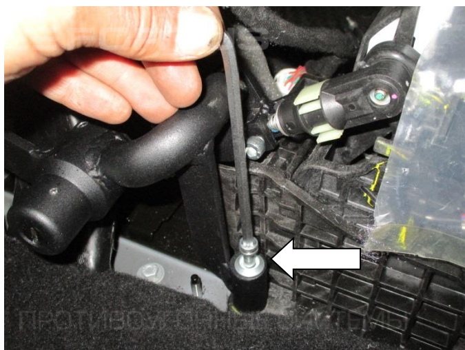
15. Установите замок (поз. 1) и закрепите заднюю точку крепления болтом (поз. 8) с шайбой (поз. 10)
