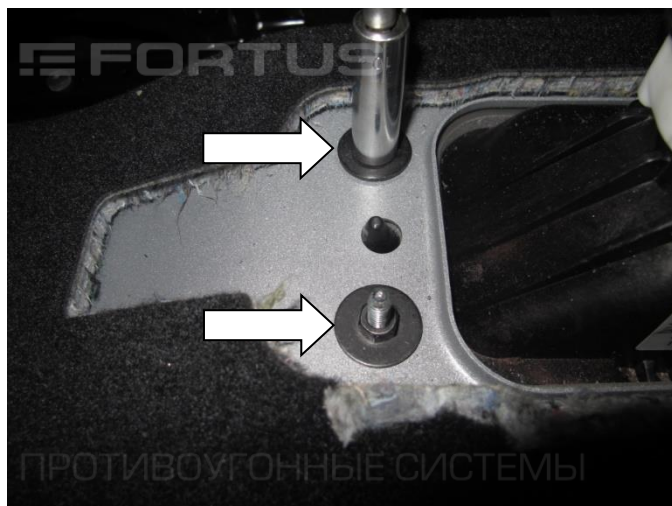
8. Открутите две гайки крепления селектора
