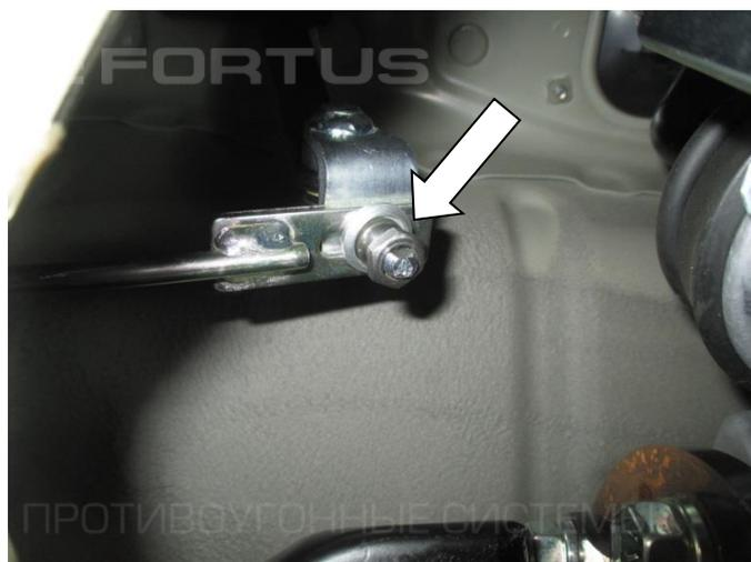
**12.** Установите на штатное место тягу КПП и прикрутите гайкой (поз. 6) с шайбой (поз. 7)
