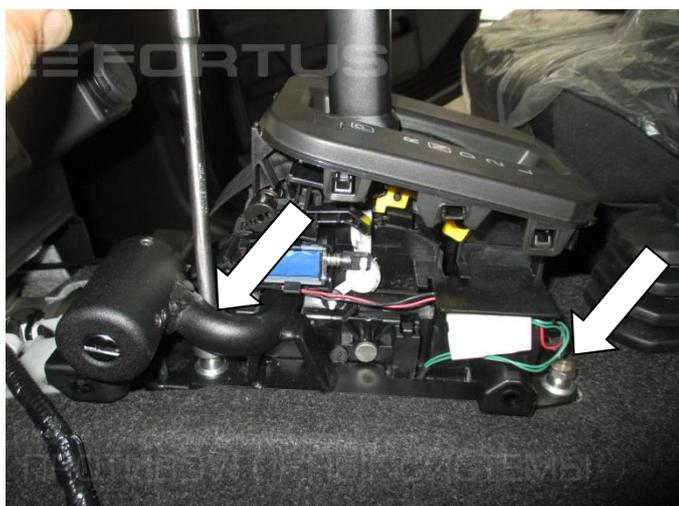
**11.** Установите селектор обратно и закрепите правые точки крепления штатными гайками. Установите замок (поз. 1) и закрепите двумя гайками (поз. 6) с шайбами (поз. 7)
