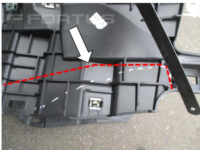
23. Удалите часть пластика консоли под корпус и трубу замка (поз. 1)
