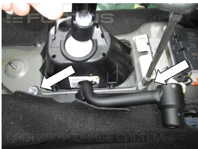
21. Установите замок (поз. 1), закрепив с помощью болта (поз. 3) с шайбой (поз. 4). Проверьте работоспособность замка и селектора
