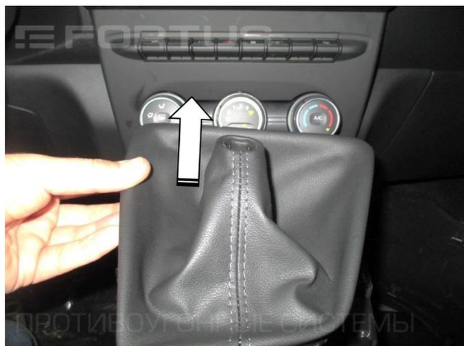
2. Снимите кожаный чехол рукоятки рычага КПП
