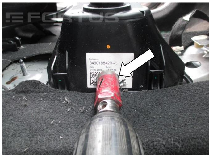
19. Приложите замок (поз. 1) к точкам крепления селектора. Разметьте и просверлите отверстие под трубу замка  $\varnothing 22$  мм
