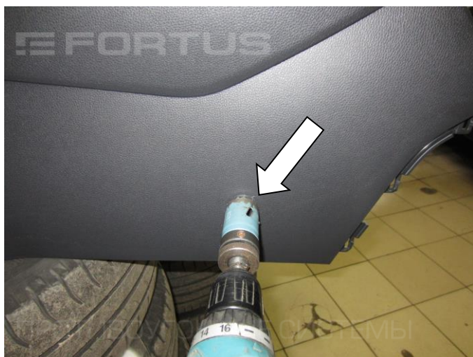
23. Разметьте и просверлите отверстие под корпус замка Ø32 мм
