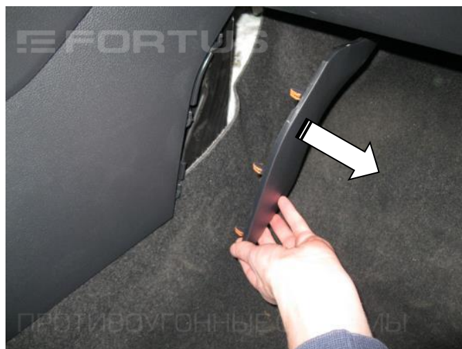
8. Снимите накладку консоли (с обеих сторон консоли)
