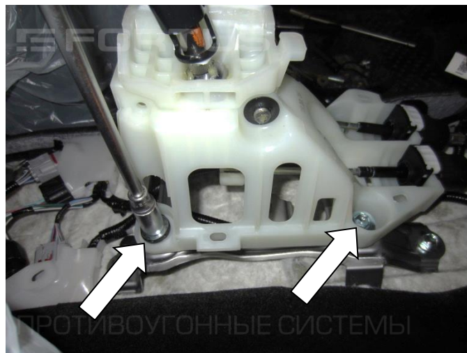
14. Открутите два болта крепления селектора
