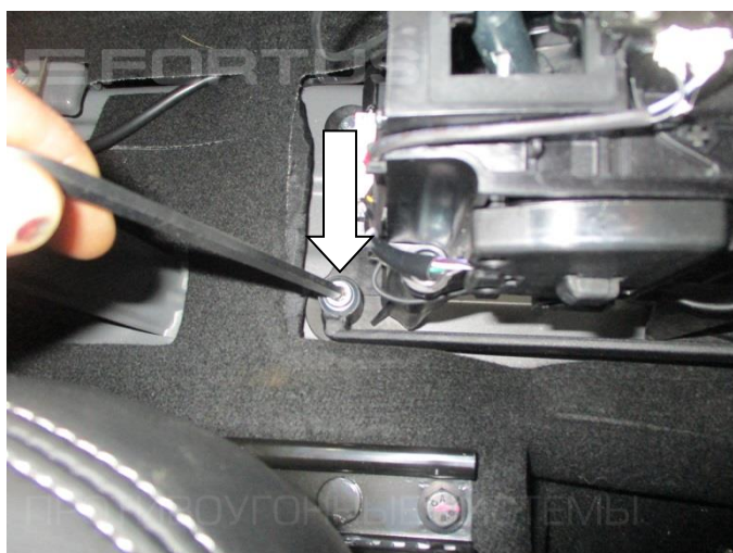
11. Установите замок (поз. 1) и закрепите заднюю точку крепления болтом (поз. 7) с шайбой (поз. 9)
