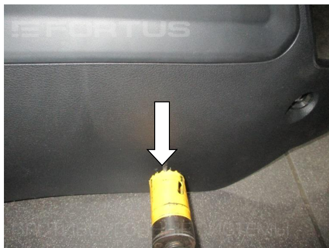
14. Установите шаблон SCH7 на корпус замка. Разметьте и просверлите отверстие под корпус замка Ø32 мм
