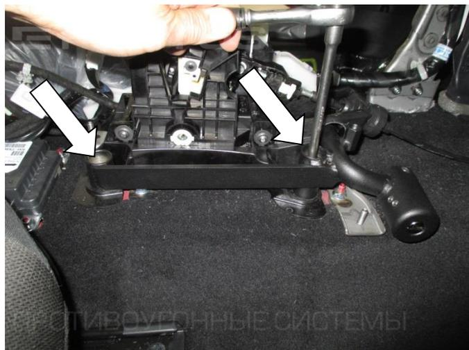
20. Установите замок (поз. 1), закрепив с помощью гаек (поз. 7)
