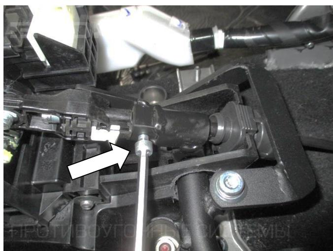
22. Установите прихват (поз. 2), закрепив с помощью болта (поз. 5)
