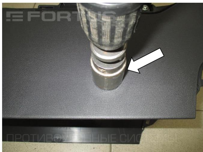
24. Разметьте и просверлите отверстие под корпус замка  $\varnothing 32$  мм
