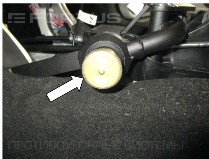
16. Установите шаблон SCH7 на корпус замка
