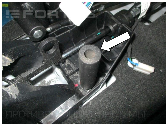
14. Установите проставку №2 (поз. 5) на переднюю правую точку крепления селектора
