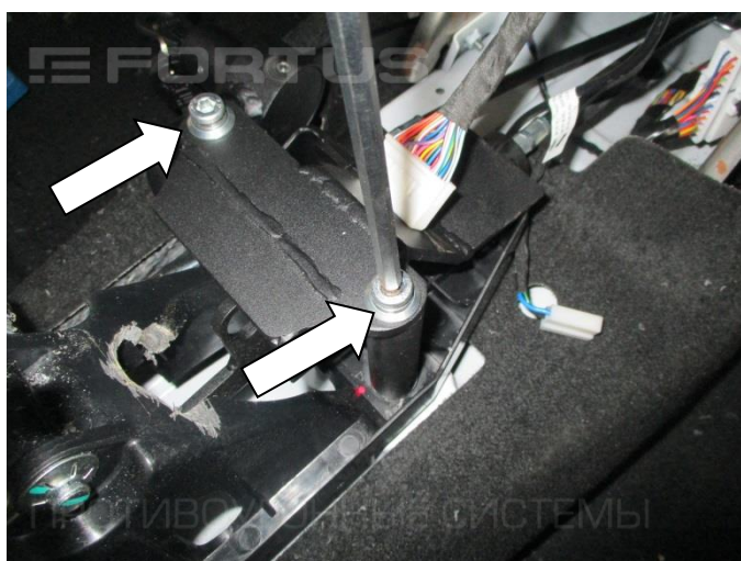
15. Установите кронштейн (поз. 3) и закрепите двумя болтами (поз. 9) с шайбами (поз. 11). Проверьте работоспособность замка и селектора
