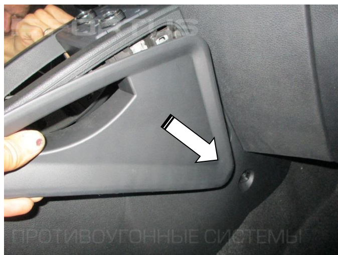
6. Снимите накладки консоли с обеих сторон
