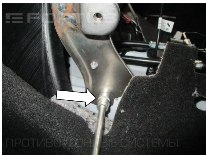
9. Открутите болт крепления кронштейна консоли
