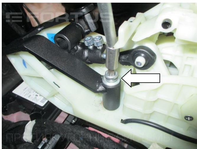
22. Установите кронштейн (поз. 3), закрепив с помощью болта (поз. 7) с шайбой (поз. 9)
