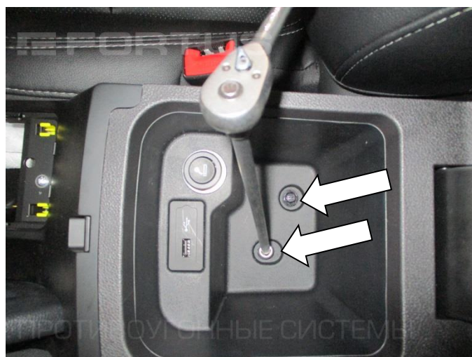
10. Открутите два болта крепления консоли
