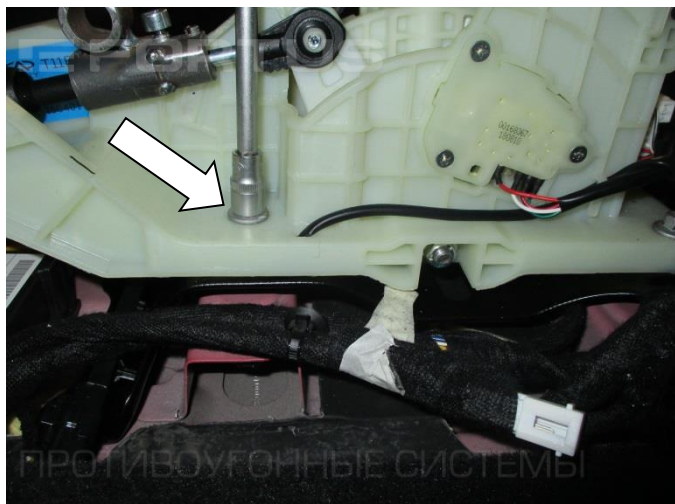
19. Открутите болт крепления селектора
