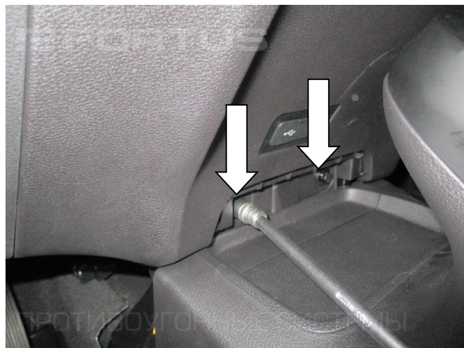
14. Открутите два болта крепления консоли
