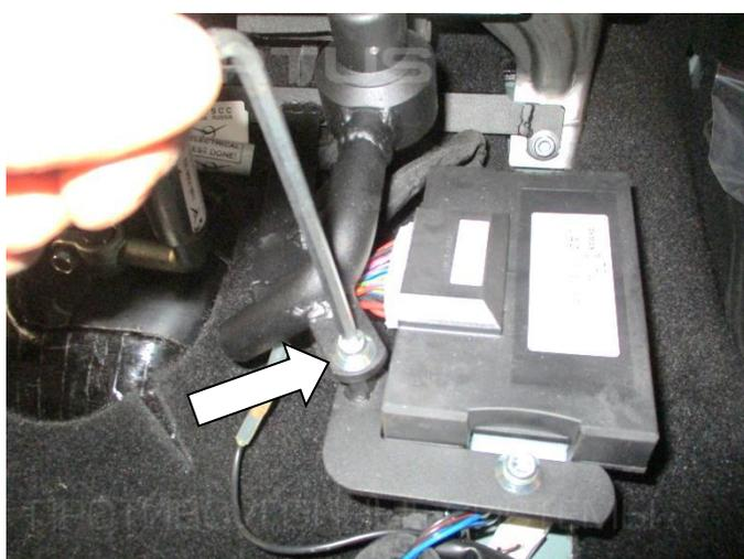
**15.** Закрепите замок (поз. 1) с помощью болта (поз. 6) с шайбой (поз. 10)
