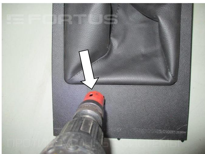
23. Просверлите отверстие под корпус замка  $\varnothing 32$  мм
