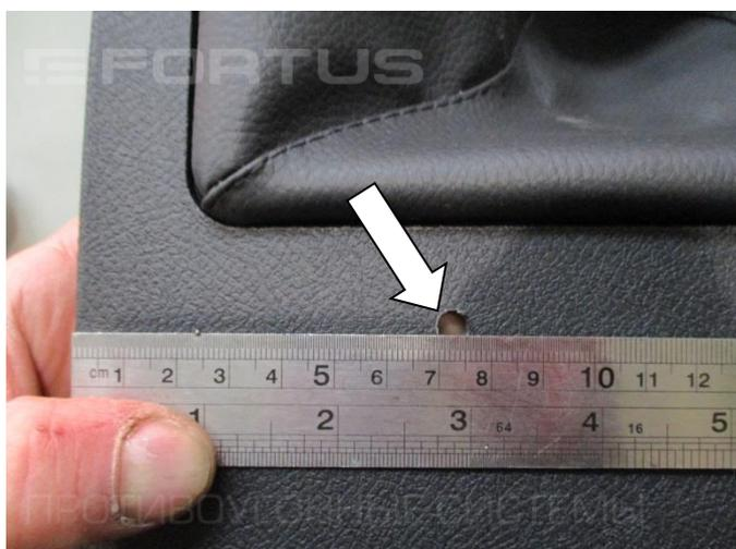
21. Разметьте отверстие под корпус замка
