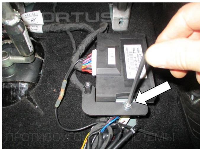
12. Установите кронштейн (поз. 4), закрепив с помощью болта (поз. 6) с шайбой (поз. 10)
