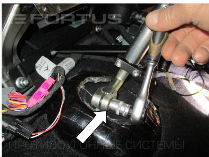
**17.** Открутите болт крепления рычага КПП
