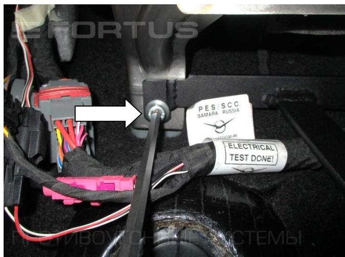
**14.** Закрепите замок (поз. 1) с помощью болта (поз. 8) с шайбой (поз. 11)
