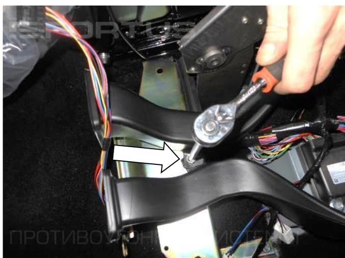
9. Открутите болт крепления воздуховода. Снимите воздуховод
