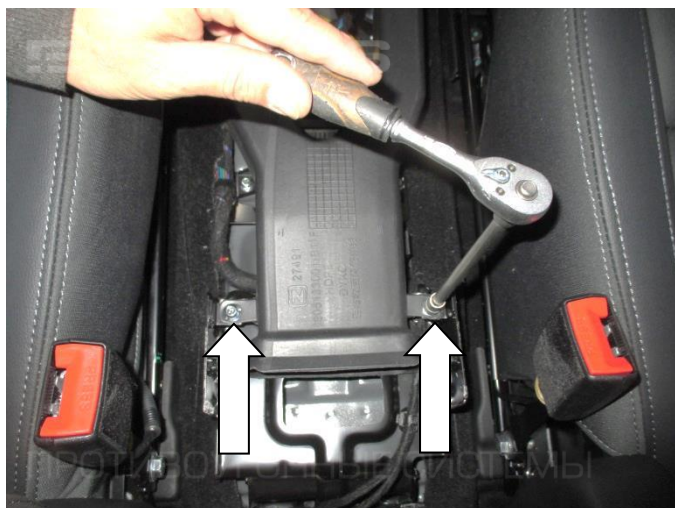
15. Открутите два болта крепления воздуховода
