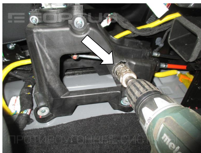
18. Приложите замок (поз. 1) по посадочным местам крепления селектора, разметьте по трубе центр отверстия и просверлите отверстие \varnothing 22 мм
