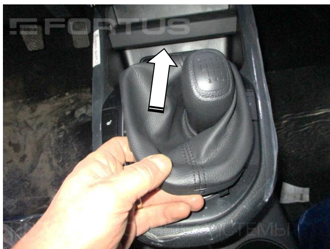
5. Отсоедините кожаный чехол рукоятки рычага КПП
