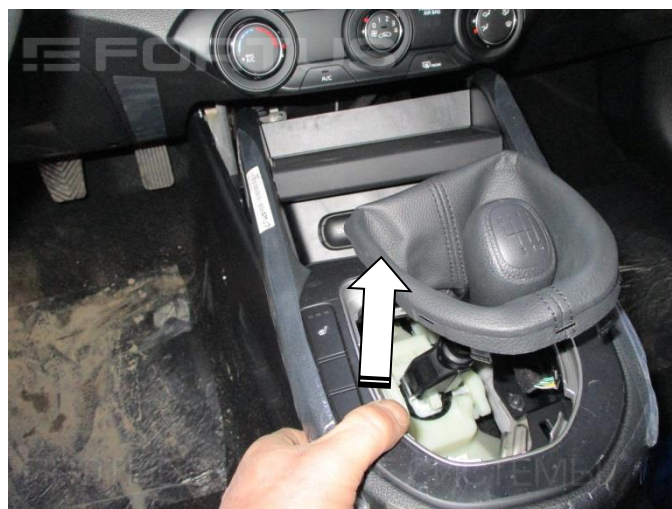
6. Снимите накладку консоли
