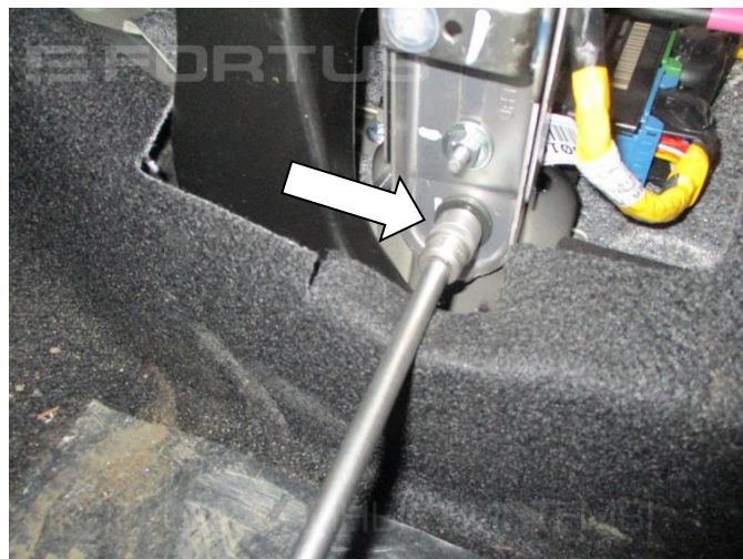
14. Открутите болт крепления кронштейна
