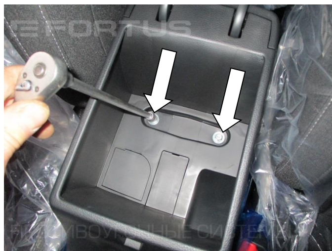
4. Открутите два болта крепления консоли
