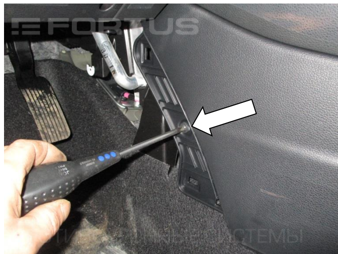
2. Открутите винты крепления консоли с обеих сторон
