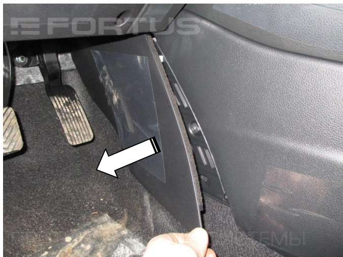
1. Снимите накладку консоли с обеих сторон
