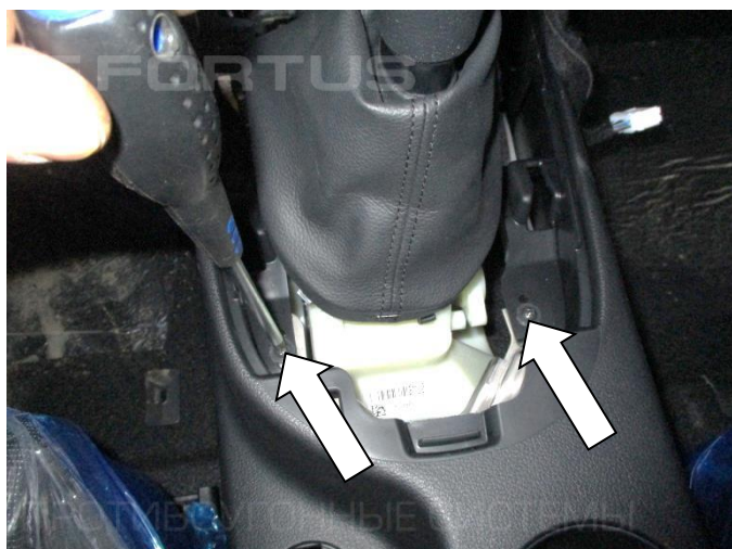
7. Открутите два винта крепления консоли
