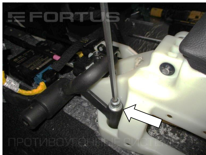
16. Установите замок (поз. 1), закрепив с помощью болта (поз. 9) с шайбой (поз. 12)
