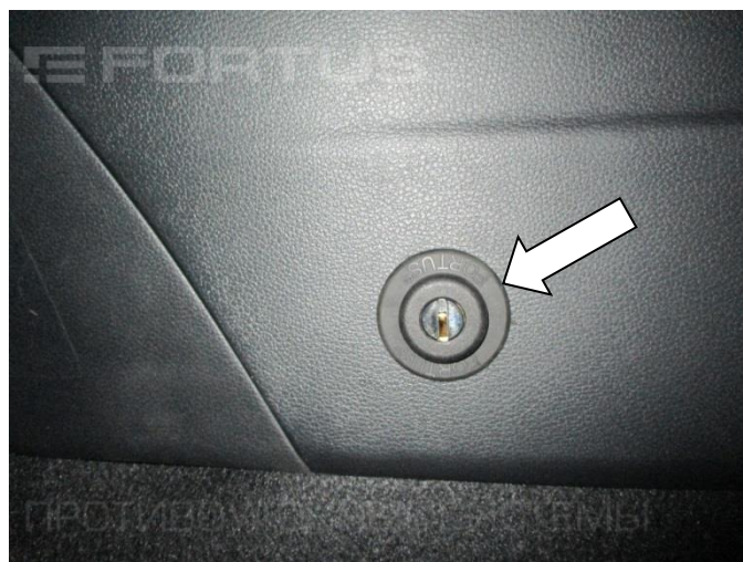
22. Проверьте работоспособность замка, сорвите крепеж, соберите консоль
