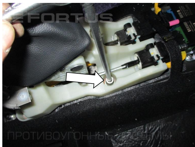
10. Открутите болт крепления селектора
