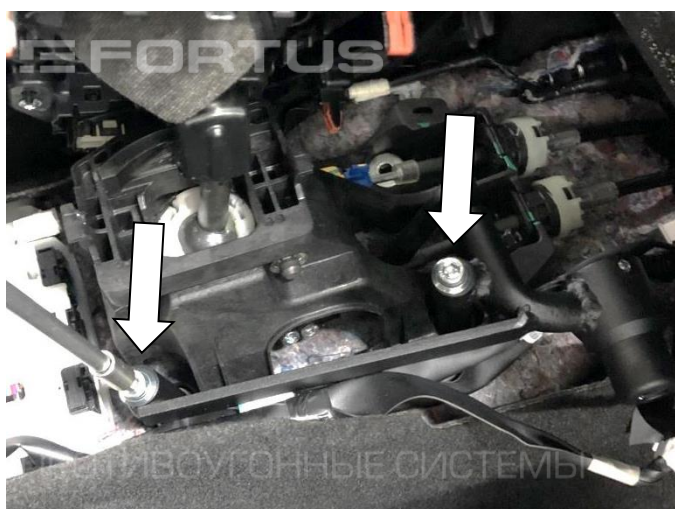
11. Установите замок (поз. 1), закрепив с помощью болтов (поз. 7, 8) с шайбами (поз. 11)
