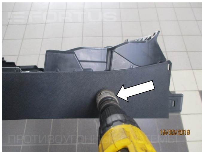
15. Разметьте и просверлите отверстие под корпус замка Ø32 мм
