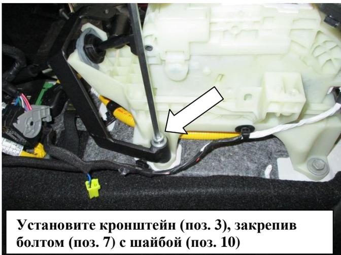
Установите кронштейн (поз. 3), закрепив болтом (поз. 7) с шайбой (поз. 10)
