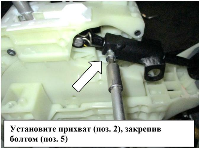
Установите прихват (поз. 2), закрепив болтом (поз. 5)
