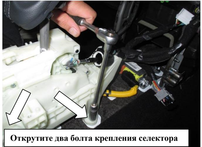
Открутите два болта крепления селектора
