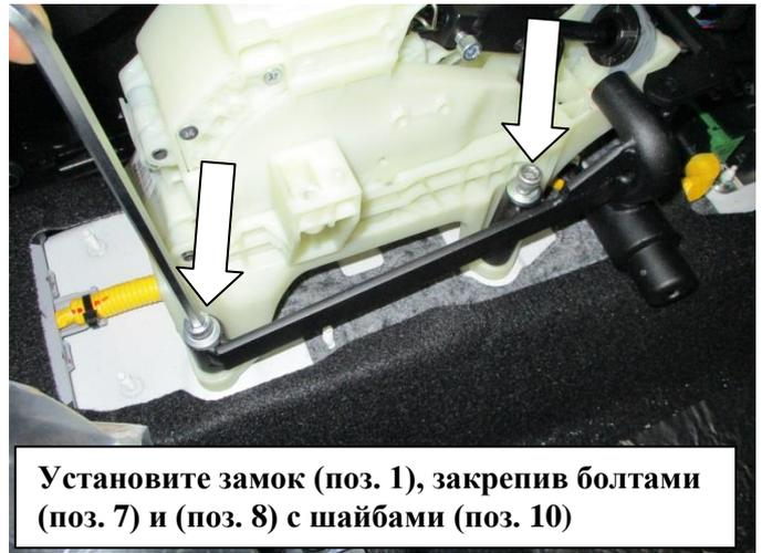
Установите замок (поз. 1), закрепив болтами (поз. 7) и (поз. 8) с шайбами (поз. 10)
