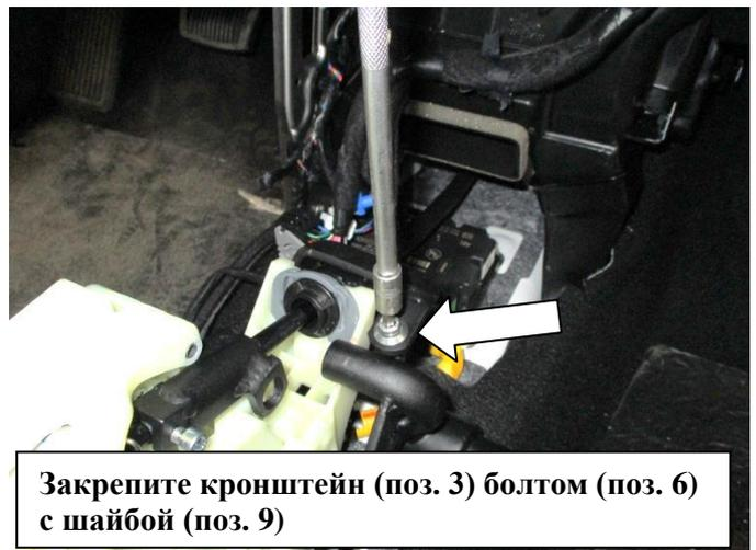
Закрепите кронштейн (поз. 3) болтом (поз. 6) с шайбой (поз. 9)
