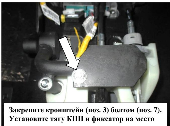
Закрепите кронштейн (поз. 3) болтом (поз. 7). Установите тягу КПП и фиксатор на место
