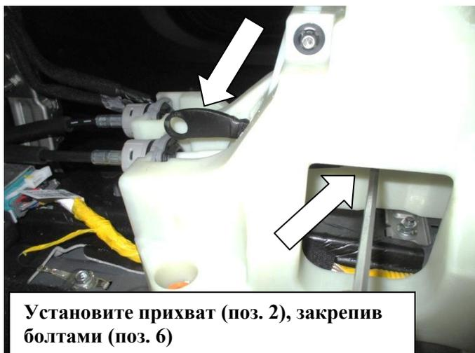
Установите прихват (поз. 2), закрепив болтами (поз. 6)
