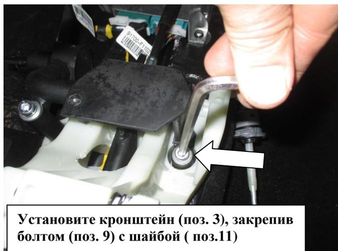
Установите кронштейн (поз. 3), закрепив болтом (поз. 9) с шайбой (поз.11)
