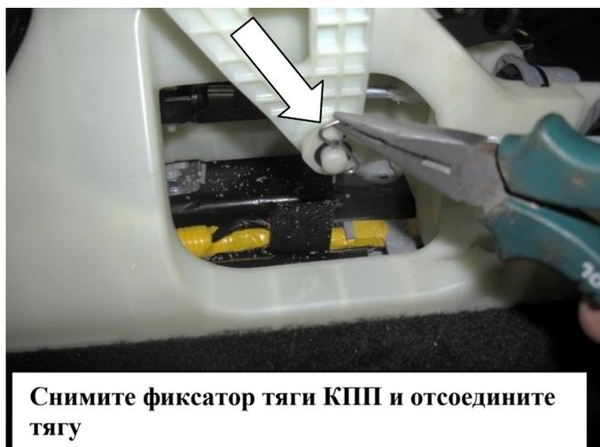
Снимите фиксатор тяги КПП и отсоедините тягу
