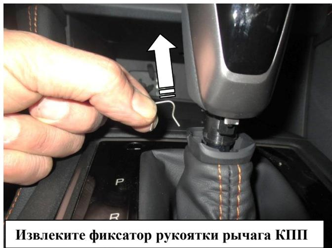
**Извлеките фиксатор рукоятки рычага КПП**
