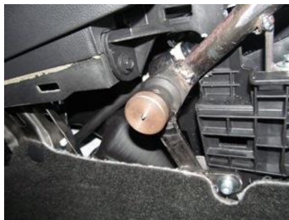
Разметить, используя разметочный шаблон, просверлить и расширить до 32 мм. отверстие в боковой крышке под корпус замка, установить боковую крышку на место
