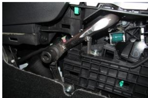
Перевести рычаг переключения передач в положение «Р», произвести блокировку, при необходимости отрегулировать положение хомута на тяге, сорвать винты
