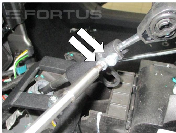
**24.** Установите прихват (поз. 2), закрепив с помощью болтов (поз. 5)
