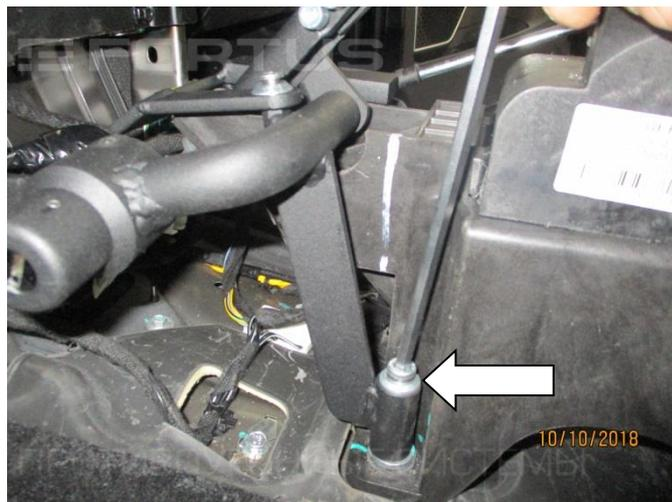
**20.** Установите замок (поз. 1), закрепив с помощью болта (поз. 8) с шайбой (поз. 11)
