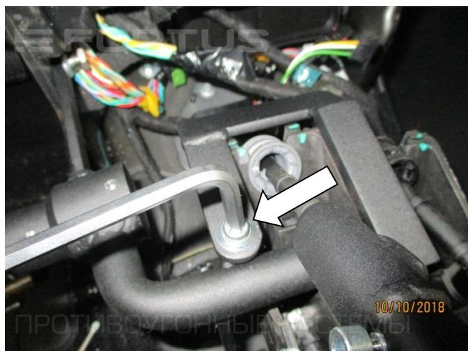
**22.** Закрепите кронштейн (поз. 3) с помощью болта (поз. 6) с шайбой (поз. 10)
