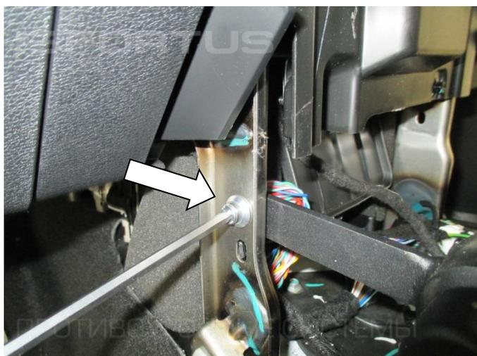
27. Закрепите замок (поз. 1) с помощью болта (поз. 7) с шайбой (поз. 11)
