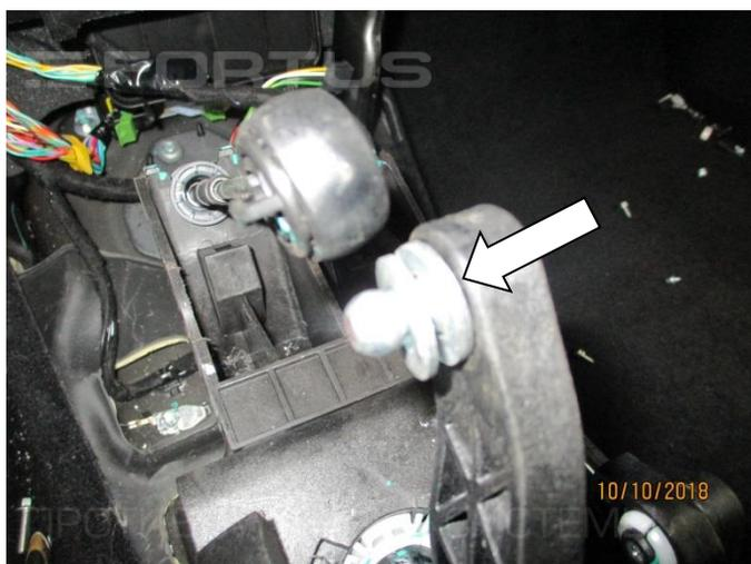
**23.** Установите регулировочные шайбы (поз. 12)
