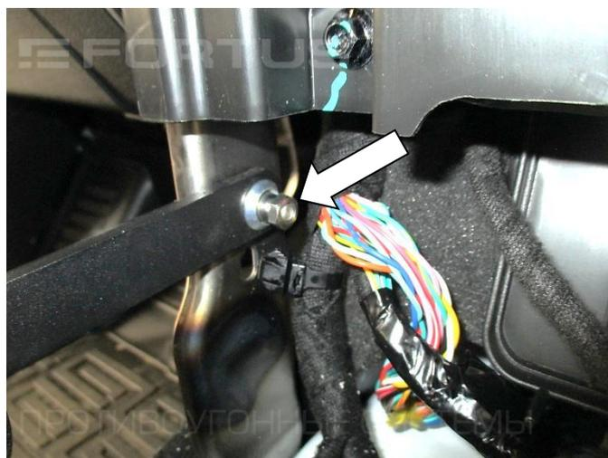
28. Закрепите замок (поз. 1) с помощью гайки (поз. 9) с шайбой (поз. 11)
