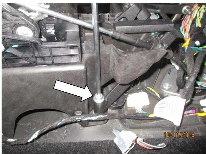
**21.** Установите кронштейн (поз. 3), закрепив с помощью болта (поз. 8) с шайбой (поз. 11)
