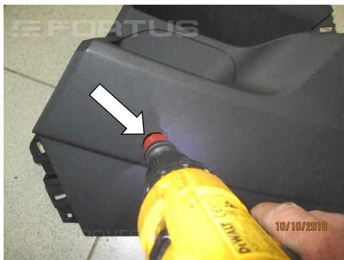
30. Разметьте и просверлите отверстие под корпус замка Ø32 мм
