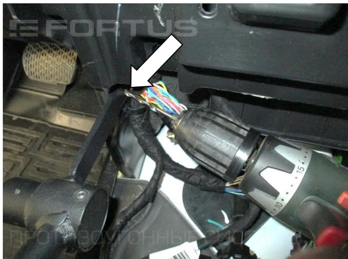
25. Через отверстие в замке (поз. 1) наметьте центр сверления кронштейна
