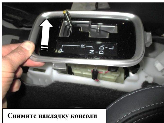
Снимите накладку консоли
