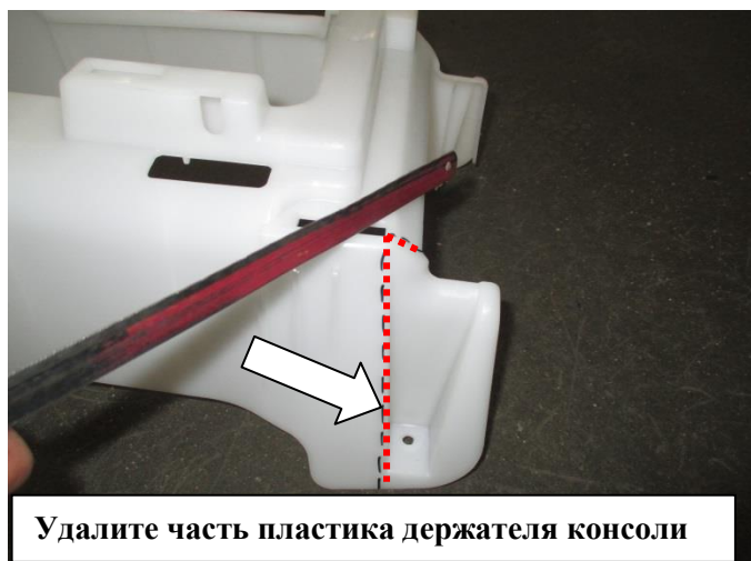
Удалите часть пластика селектора
