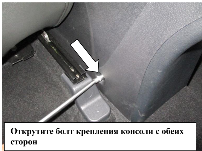
Открутите два винта крепления консоли
