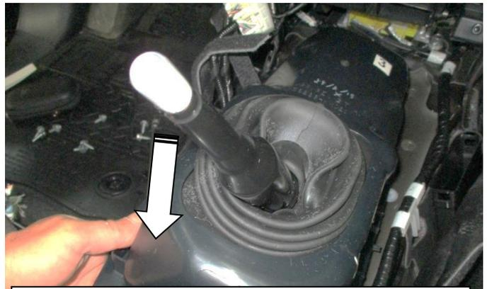
Снимите замок (поз. 1). Установите накладку селектора обратно
