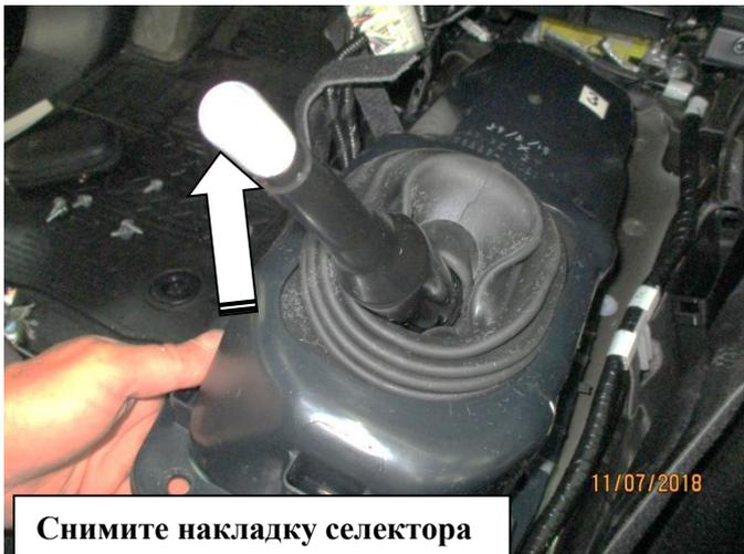
Снимите накладку селектора
