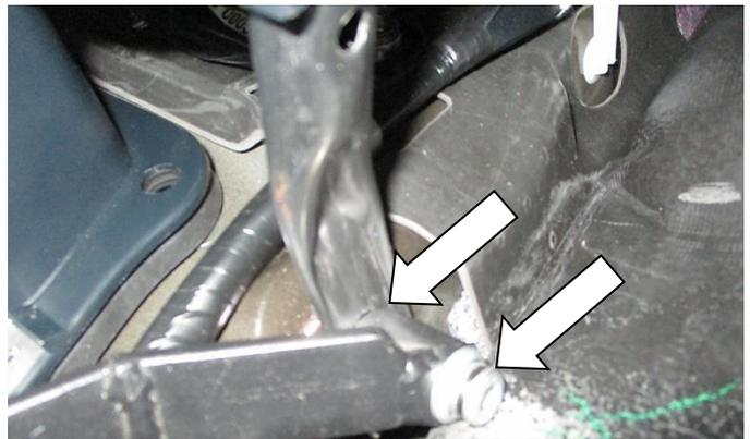
Закрепите замок (поз. 1) через проставку (поз. 4) болтом (поз. 7) с шайбой (поз. 9)
