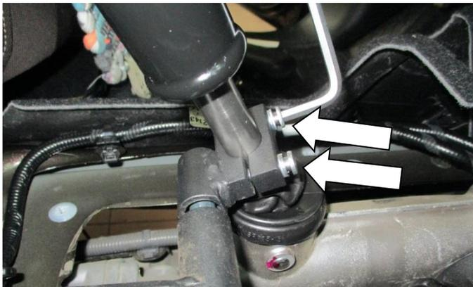
Установите прихват (поз. 2) и хомут (поз. 3), закрепив болтами (поз. 6). Сорвите крепеж
