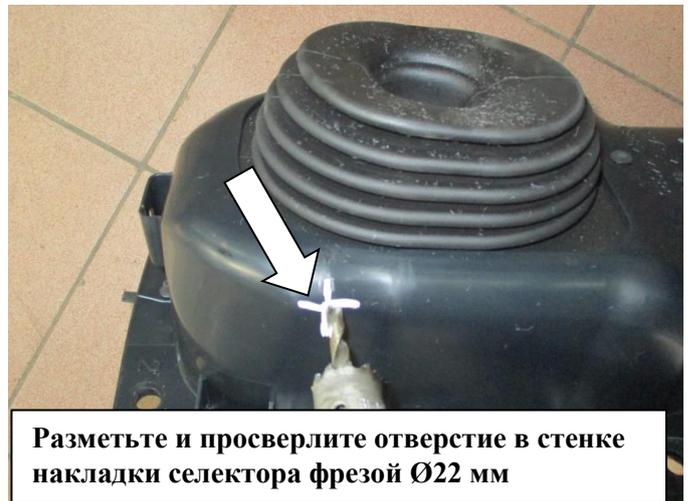
Разметьте и просверлите отверстие в стенке накладки селектора фрезой Ø22 мм
