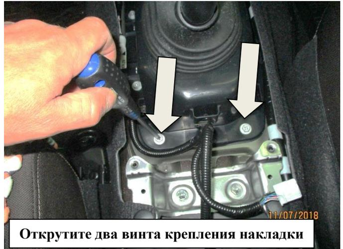
Открутите два винта крепления накладки
