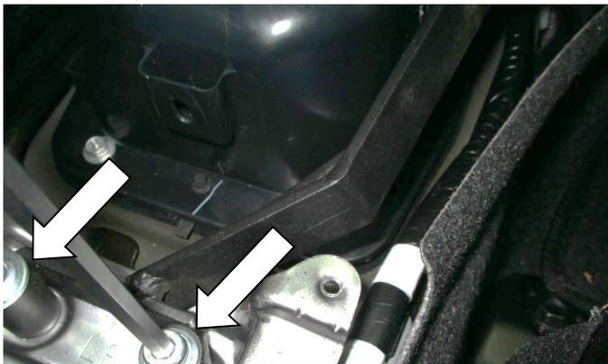
Установите замок (поз. 1), закрепив болтами (поз. 8) с шайбами (поз. 9)
