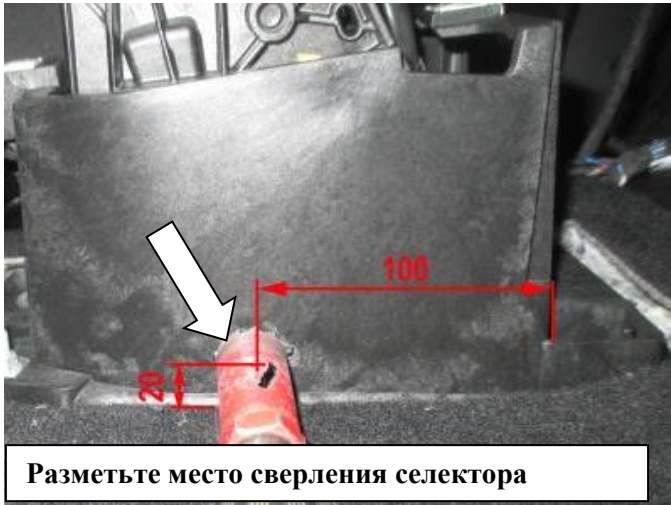
Просверлите отверстие \varnothing 22 мм в коробе селектора и в стенке селектора
