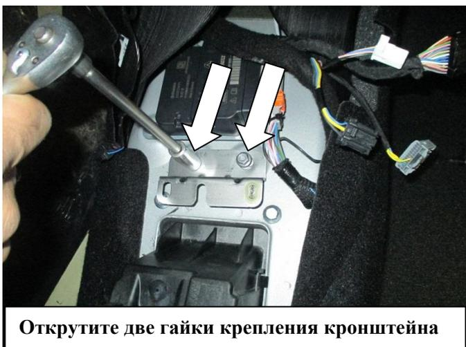
**Открутите две гайки крепления кронштейна**
