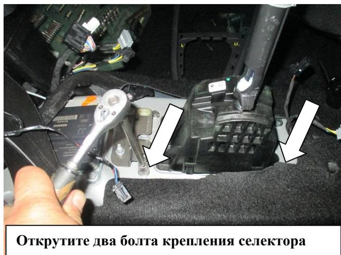
**Открутите два болта крепления селектора**
