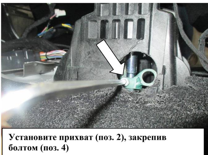
**Установите прихват (поз. 2), закрепив болтом (поз. 4)**
