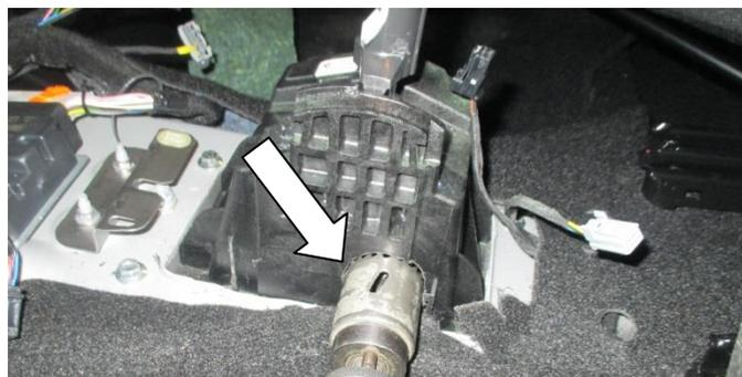
**Приложите замок (поз. 1) по посадочным местам крепления селектора. Разметьте и просверлите отверстие в стенке селектора фрезой Ø41 мм**
