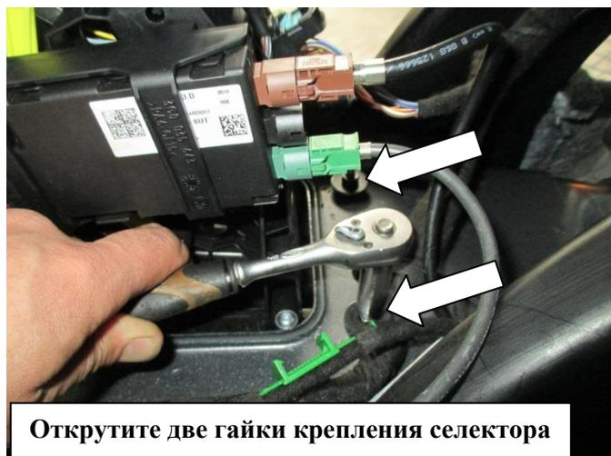
Открутите две гайки крепления селектора
