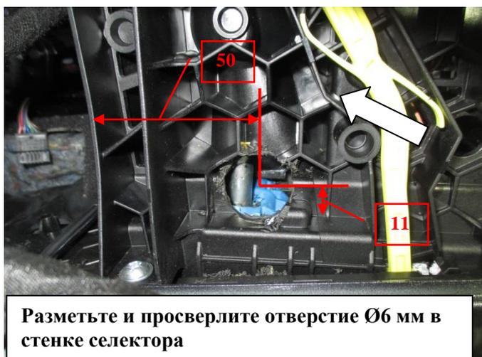
Разметьте и просверлите отверстие Ø6 мм в стенке селектора
