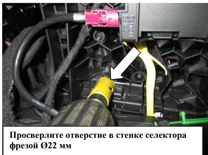
Просверлите отверстие в стенке селектора фрезой Ø22 мм
