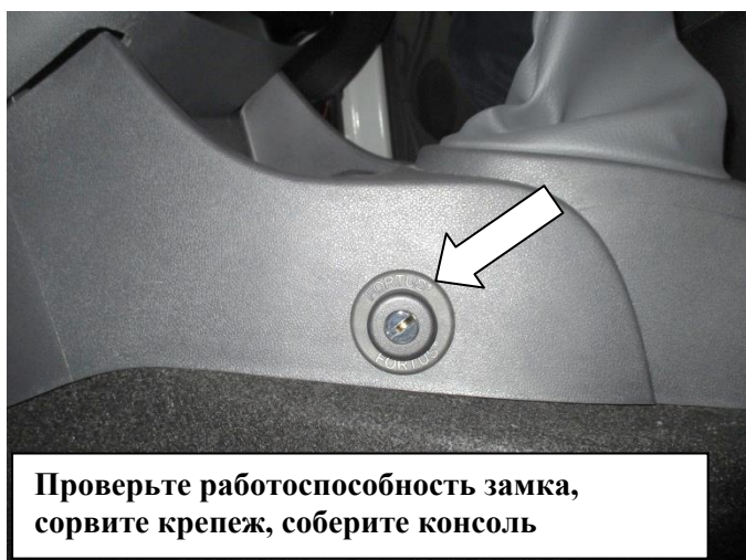
Установите шаблон SCH7 на корпус замка
