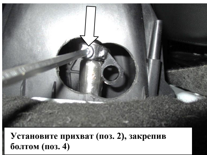
Открутите болт крепления селектора
