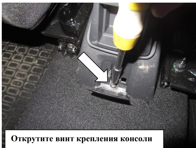
Снимите накладку консоли
