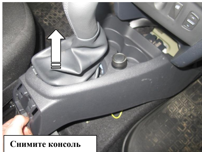
Открутите два винта крепления консоли
