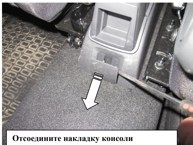
Снимите накладку консоли
