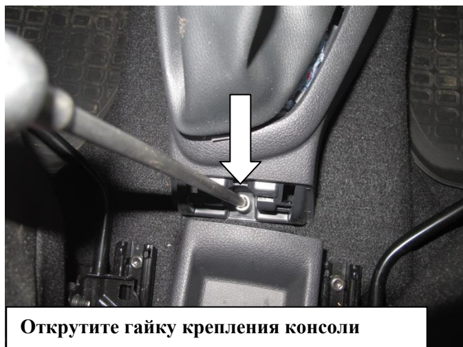
Снимите накладку консоли
