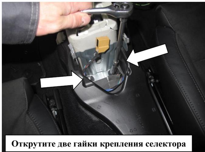
Открутите две гайки крепления селектора
