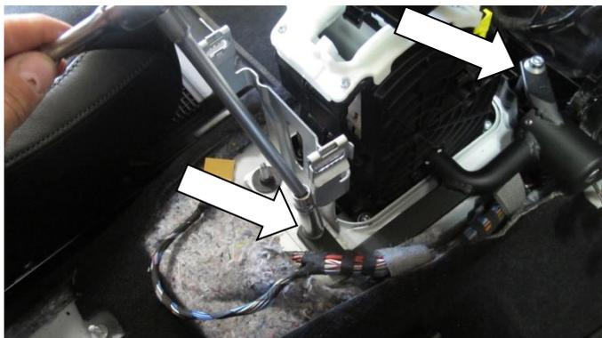
Установите замок (поз. 1), закрепив винтом (поз. 5) с шайбой (поз. 7) и гайкой (поз. 6) с шайбой (поз. 7)
