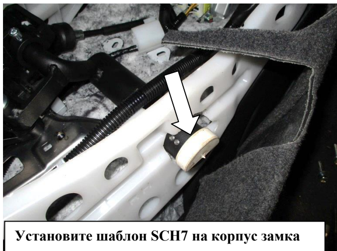
Разметьте и просверлите отверстие под корпус замка \varnothing 32 мм
