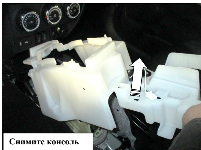
Удалите часть пластика консоли
