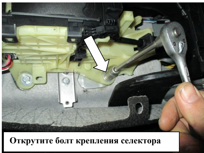
Открутите болт крепления селектора
