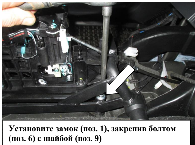
Закрепите замок (поз. 1) с помощью болта (поз. 6) с шайбой (поз. 9)
