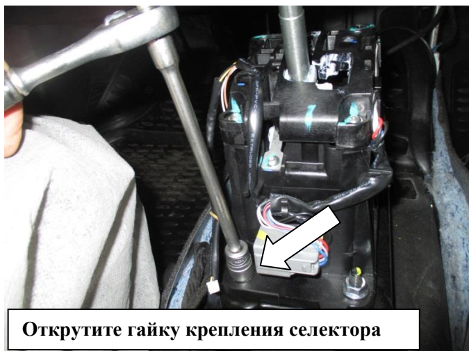
Закрепите селектор двумя гайками (поз. 8) с шайбами (поз. 9). Сорвите крепеж
