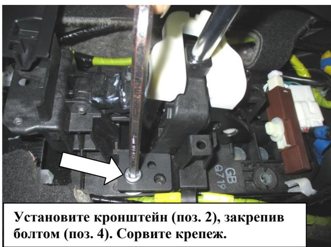
Установите кронштейн (поз. 2), закрепив болтом (поз. 4). Сорвите крепеж.
