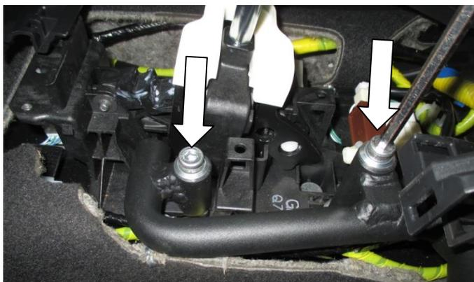
Установите замок (поз. 1), закрепив болтами (поз. 5, 6) с шайбами (поз. 7)
