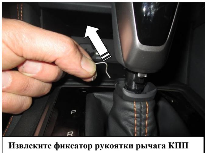
Извлеките фиксатор рукоятки рычага КПП
