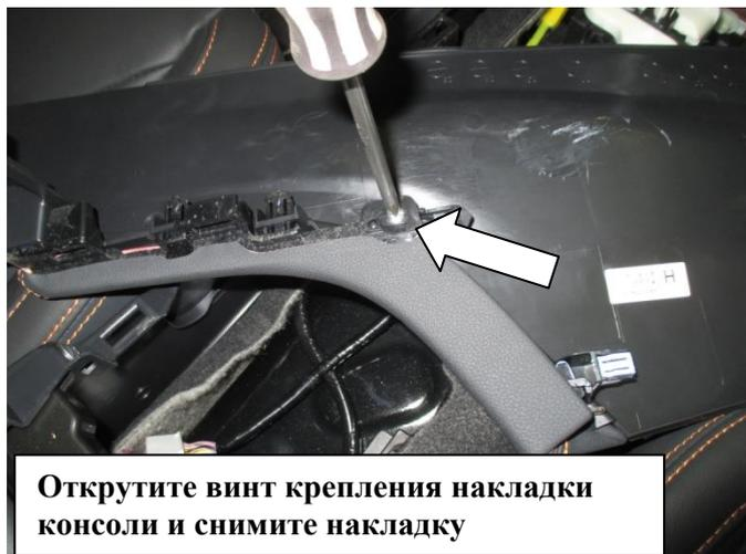
Открутите винт крепления накладки консоли и снимите накладку
