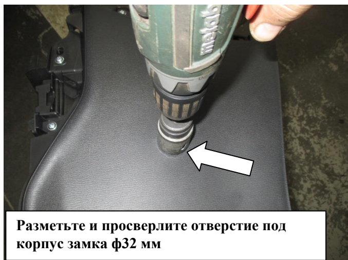
Удалите часть пластика консоли
