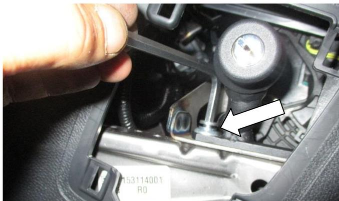
Закрепите замок (поз. 1) с помощью болта (поз. 4) с шайбой (поз. 6)
