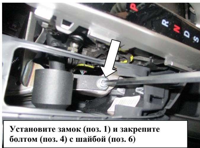
Установите замок (поз. 1) и закрепите болтом (поз. 4) с шайбой (поз. 6)
