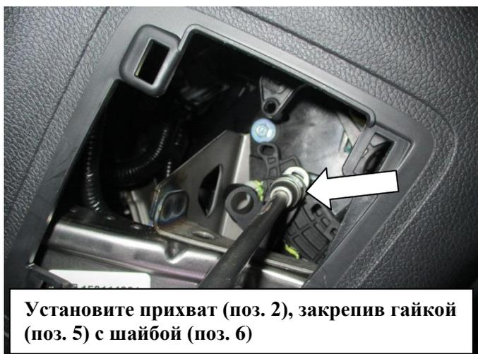
Установите прихват (поз. 2), закрепив гайкой (поз. 5) с шайбой (поз. 6)
