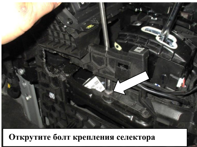
Открутите болт крепления селектора
