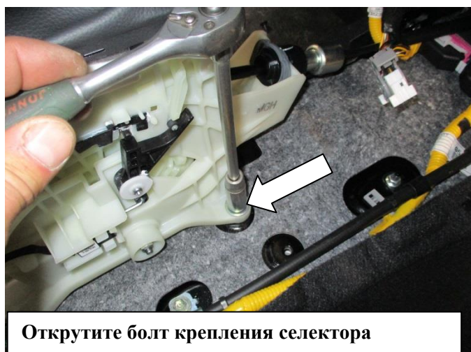
Открутите болт крепления селектора
